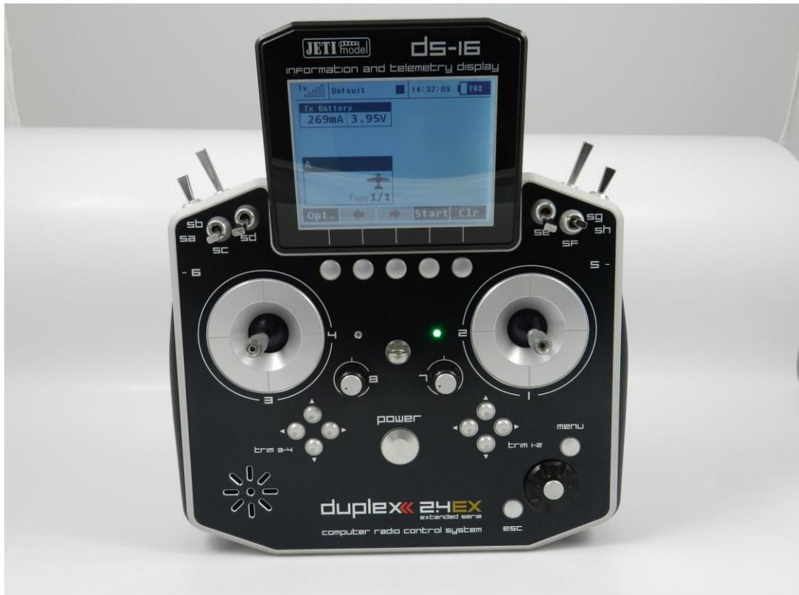
Schalter SA: 3-stufen, kurz
