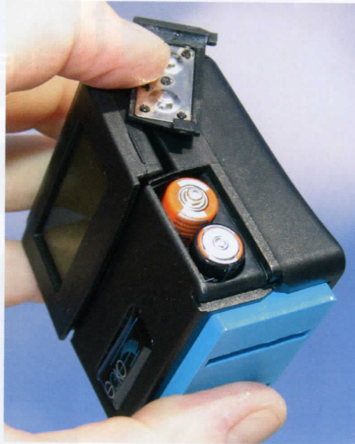
Herkömmliche AAA-Batterien versorgen das Präzisionsinstrument mit Strom
