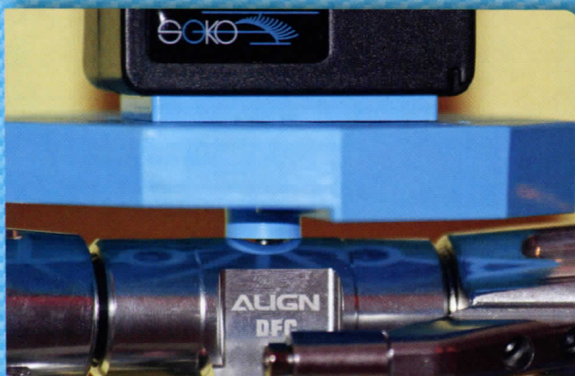
Nicht ganz optimal. Die Plattform lässt sich nicht in der Bohrung des Zentralstücks zentrieren und liegt nur an dem Radius auf. Passscheiben in der richtigen Größe könnten als Unterlage dienen.
