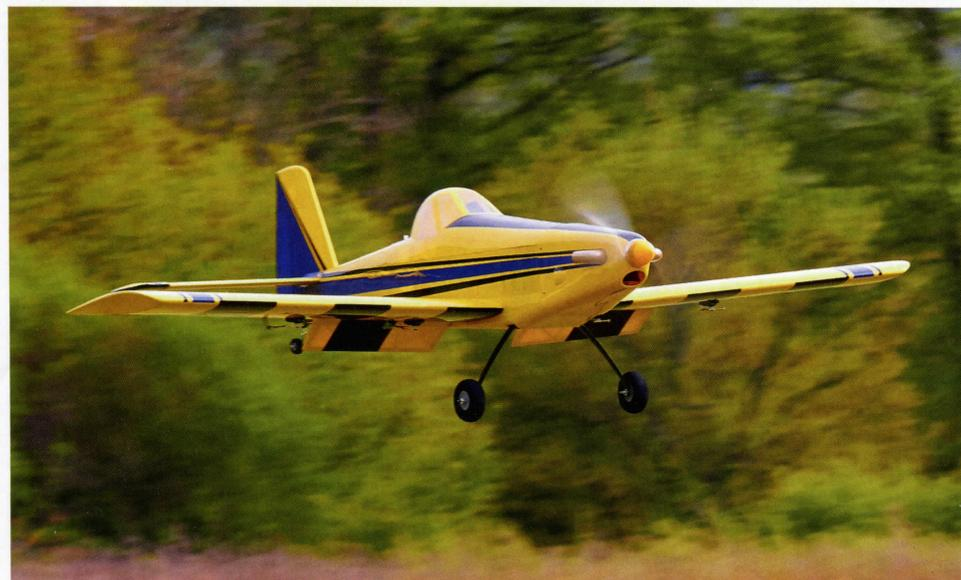
Die großen Landeklappen ermöglichen zielgenaue Landeanflüge. Zum Start wird mit halb gesetzten Klappen in Dreipunktlage abgehoben
