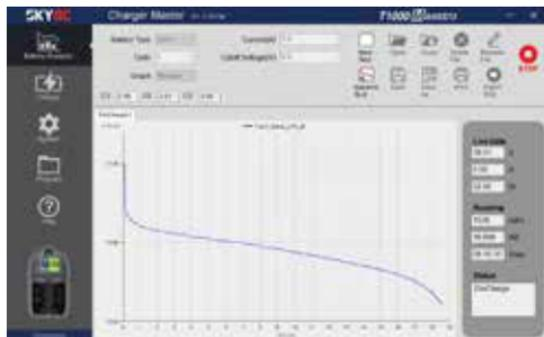
2. Geben Sie den Akkutyp, den Entladestrom, die Abschaltspannung und andere Parameter an.
