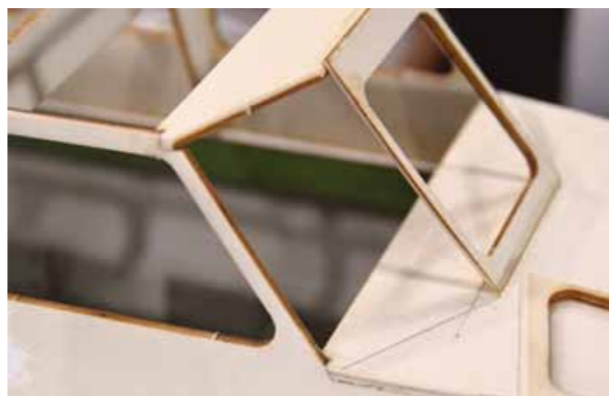
Einbau der Frontscheibenrahmen
