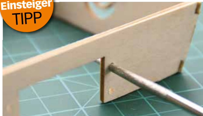
Vorbereiten des Servoträgers. Auch diese Löcher sollten eher aufgefeilt als aufgebohrt werden, damit nichts ausreißt
