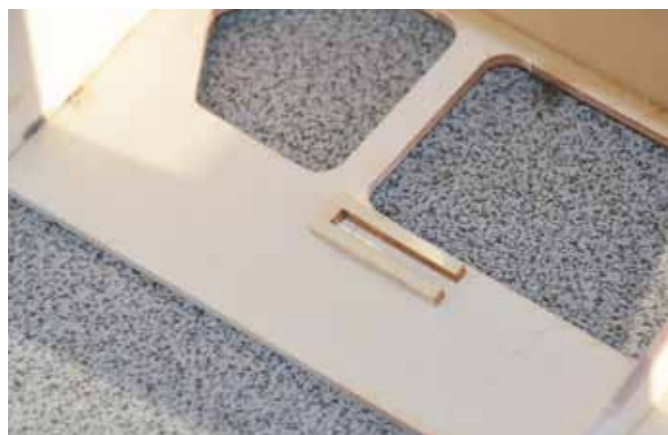
Aufnahme des Motorträgers für das Radar
