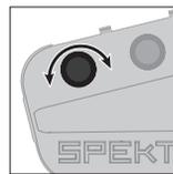
Drehen Sie den ST Rate Drehknopf gegen den Uhrzeigersinn um den Gainwert zu reduzieren.
