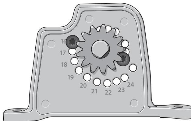
**WICHTIG:** Das im Lieferumfang enthaltene 16T Zahnradgetriebe ist für den Einsatz mit einem 6S oder 8S Li-Po-Akku geeignet.
