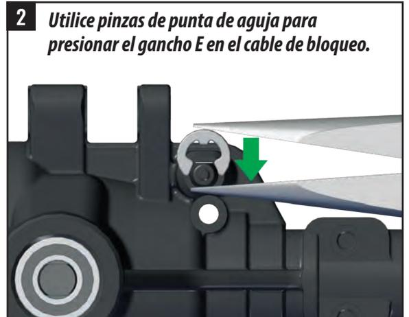
Utilice pinzas de punta de aguja para presionar el gancho E en el cable de bloqueo.
