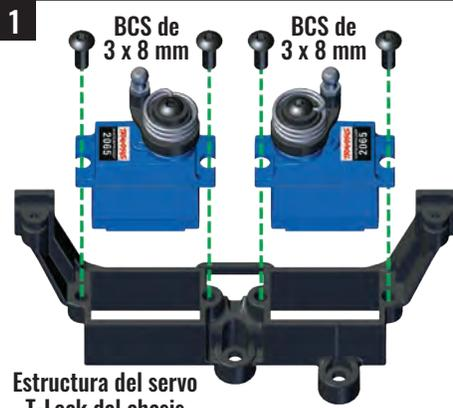
Estructura del servo T-Lock del chasis
