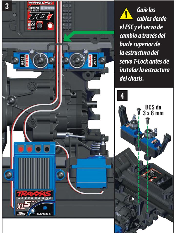
**!** Guíe los cables desde el ESC y el servo de cambio a través del bucle superior de la estructura del servo T-Lock antes de instalar la estructura del chasis.
