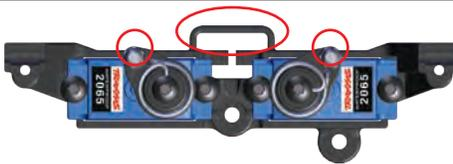
Tenga en cuenta la orientación del brazo del servo. Las estructuras de la copa de bola deben estar en el mismo lado que el bucle superior de la estructura del servo.
