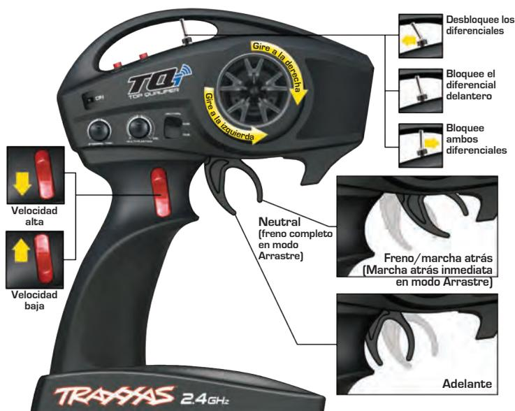
**Nota:** Regrese el gatillo del transmisor a la posición neutra y presiónelo hacia arriba nuevamente para activar la marcha atrás, a menos que el ESC esté en modo Arrastre (consulte la sección "Selección de un modo de velocidad" para obtener información adicional).
