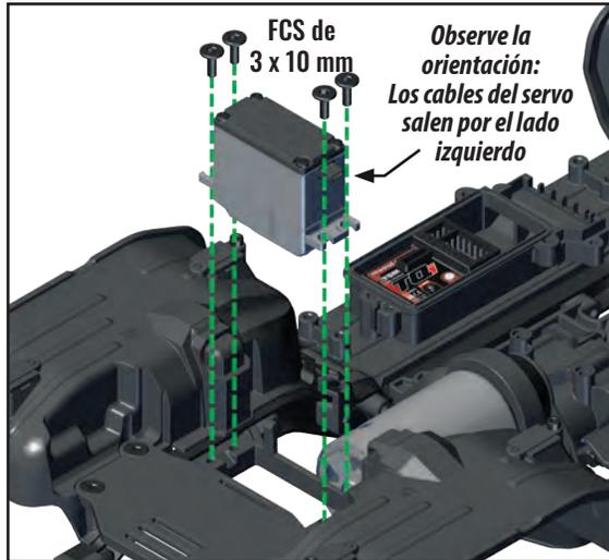
Acople los cables en los retenedores de la estructura del servo y el riel del chasis hacia la caja del receptor
