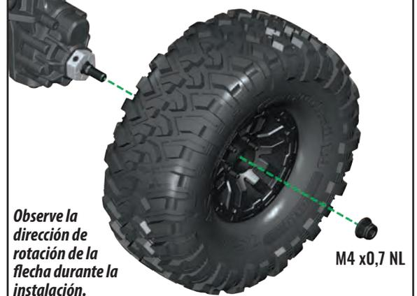
*Observe la dirección de rotación de la flecha durante la instalación.*
