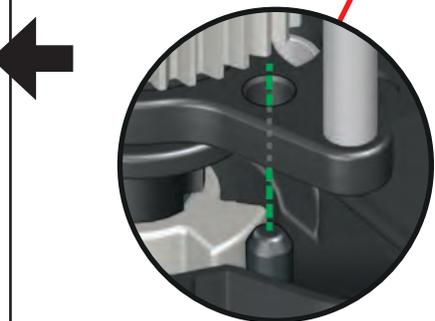
Alinee la horquilla de cambio con el pasador moldeado en la mitad de la caja de transmisión.
