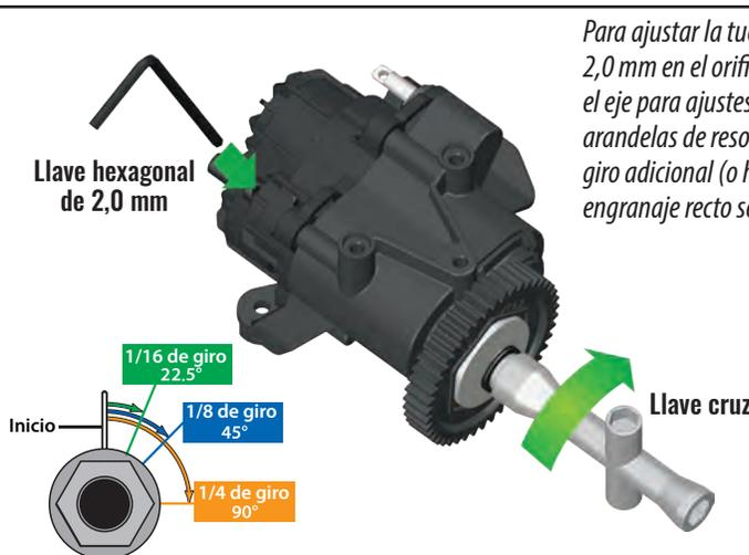
Para ajustar la tuerca deslizante, introduzca una llave hexagonal de 2,0 mm en el orificio del extremo del eje de entrada. Esto bloquea el eje para ajustes. Gire la tuerca de ajuste hasta que las cuatro arandelas de resorte estén planas; luego, apriete la tuerca 1/16 de giro adicional (o hasta que el embrague deslizante no permita que el engranaje recto se deslice durante el funcionamiento normal).
