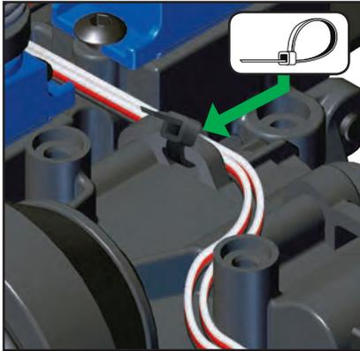
Ate el exceso de cable en la caja del receptor
