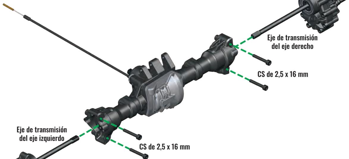
Eje de transmisión del eje izquierdo
