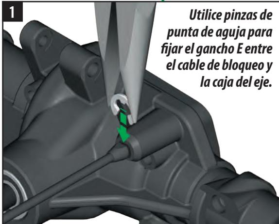
Utilice pinzas de punta de aguja para fijar el gancho E entre el cable de bloqueo y la caja del eje.
