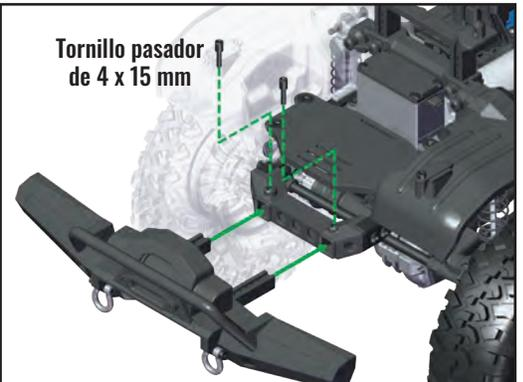
Ajuste la longitud del paragolpes según sea necesario para que se adapte a la carrocería que elija para su nuevo TRX-4.
