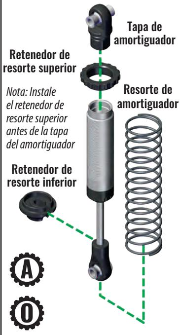
Pruebe el amortiguador para asegurarse de que se comprime por completo. Si no es así, está llenado en exceso.
