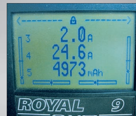
Die Ausgabe des Spannungs- und Stromsensors. Im Display des Senders Royal Pro sind bis zu drei Zeilen gleichzeitig zu beobachten.
