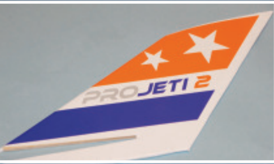
Das Leitwerk besteht – recht untypisch für ein Schaummodell – aus Balsaholz, mit Dekorbögen beklebt.
