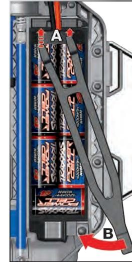
Setzen Sie die Batterie mit den Kabeln zur Rückseite des Modells ein. Führen Sie die Laschen der Batterie in die Schlitzte der Batteriehalterung ein (A). Drehen Sie die Batteriehalterung in Richtung des Chassis' und rasten (festklemmen) Sie das Ende in den vorderen Haltebügel (B).
