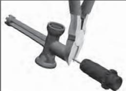
C. Entfernen/Montieren des Stabendes
