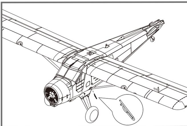
3. Fixez les panneaux d'ailes au fuselage à l'aide des 4 vis, comme montré. Assurez-vous que ces vis sont bien serrées.
