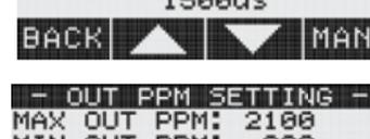
Betätigen Sie den angezeigten Wert der Impulsbreite, damit das Servo in die entsprechende Position läuft. Um einen automatischen Servolauf innerhalb der eingegebenen Grenzen zu starten, muss die Schaltfläche „AUTO“ berührt werden. Um zum manuellen Modus zurück zukehren, muss die Schaltfläche „MANU“ betätigt werden. Mit „BACK“ gelangt man zum vorherigen Menü zurück.
