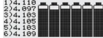
1. Berühren Sie die Schaltfläche „BATT“ in der Hauptanzeige, um die Funktionen des Akkumonitor zu nutzen. Danach wird das nebenstehende Display angezeigt, in dem die Spannungslagen der einzelnen Zellen visualisiert werden.
