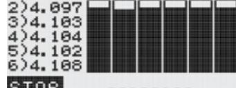
4. Um einen reinen Balanciervorgang durchzuführen berühren Sie die Schaltfläche „BALA“. Der Vorgang, bei dem das nebenstehende Display zu sehen, wird automatisch beendet, wenn die Spannungslagen genau angeglichen sind. Mit „STOP“ kann ein laufender Vorgang jederzeit abgebrochen werden.
