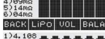
3. Berühren Sie die Schaltfläche „IR“. Danach öffnet sich ein Display mit einer grafischen Anzeige der einzelnen Werte des Innenwiderstands der Zellen. Die aktuellen Daten werden auch als Zahlenwert angezeigt.
