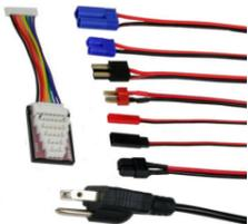
Neben dieser Anleitung gehören zum Lieferumfang ein AC- und ein DC Anschlusskabel, sowie Ladekabel mit verschiedenen Steckernormen (EC3, EC5, Traxxas, Deans, Futaba, und JST). Eine Balancer Adapterplatinen für 2S - 6S Akkus nach dem JST / XH Stecksystem komplettiert den Lieferumfang. Für andere Balancerstecker können optional weitere Multi-Adapter Platinen erworben werden
