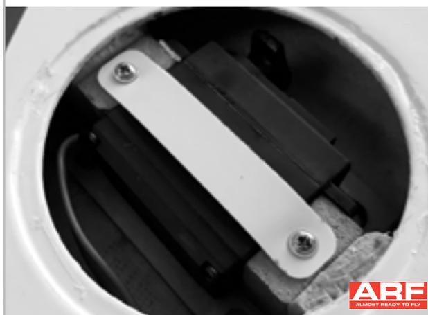
Das Servo im Rahmen mit Lasche festschrauben und den sicheren Sitz des Servos überprüfen.
