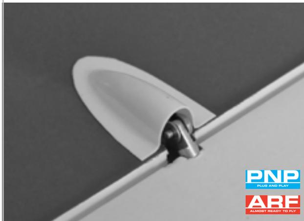
Schneiden Sie die Hutzen aus und kleben Sie sie mit UHU Por an.
