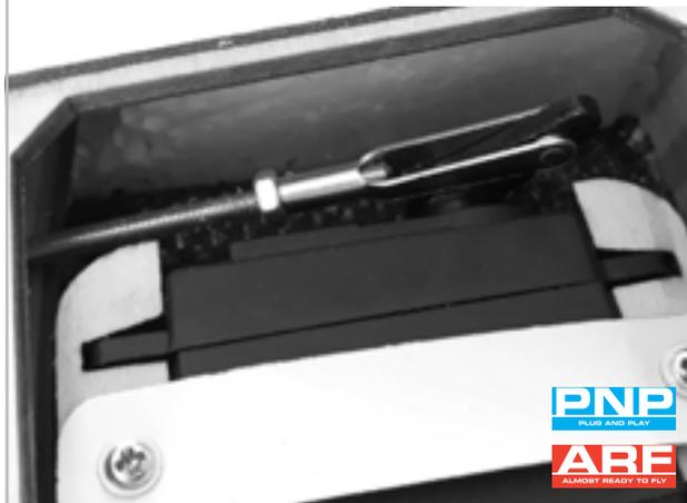
Stellen Sie das Servo auf Maximalausschlag ein, sodass das Horn nach vorne Richtung Nasenleiste zeigt. Justieren sie dann ggf. das Gestänge in der Länge und hängen Sie es in das zweite Loch von außen in das Servohorn ein. Servo mit dem Riegel festschrauben.
