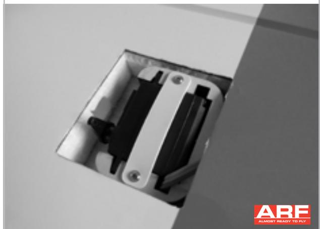
Servokabel durch den Schacht ziehen und den Rahmen mit eingebautem Servo in den Schacht kleben. UHU Endfest 300 hat sich hier bewährt, benötigt allerdings einige Stunden zum Aushärten.
