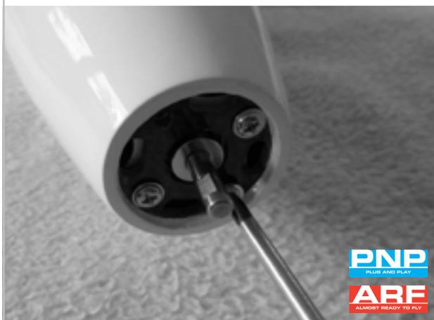
Montieren Sie den Motor. Verwenden Sie Schraubensicherungslack.
