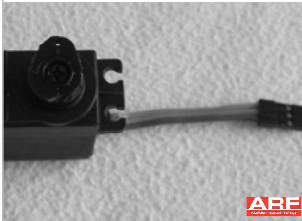
Das Servokabel auf etwa 5cm kürzen und einen kurzen Servohebel anfertigen.
