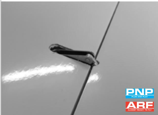
Setzen Sie die Wölbklappe so fest, dass sie maximal nach oben verwölbt ist (Speed Stellung) und hängen Sie den Gabelkopf im Ruderhorn ein.
