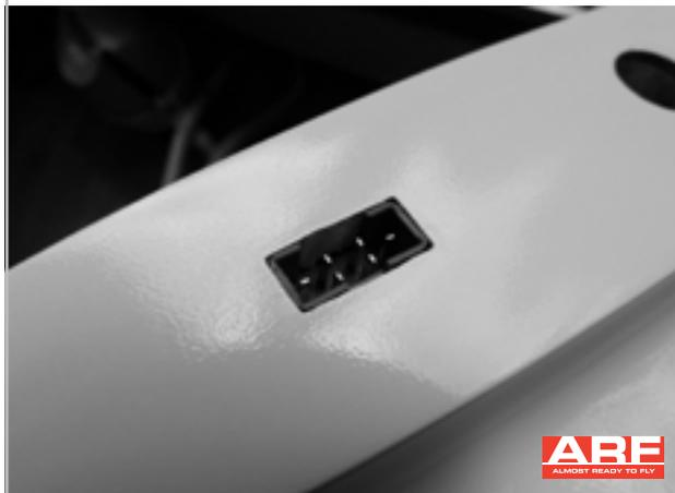
Den Kabelbaum durch den Rumpf ziehen und den Multiplexstecker bündig in die Flächenanformung kleben. Den Stecker vorher anschleifen oder mit einem Bastelmesser einritzen.
