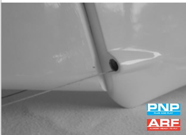
Markieren Sie am Seitenruder die Bohrlöcher für die Ruderhörner.
