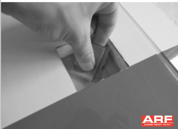
Vor dem Verkleben den Servoschacht und den Servorahmen gründlich mit grobem Schleifpapier anrauen und anschließend von Schleifstaub befreien.
