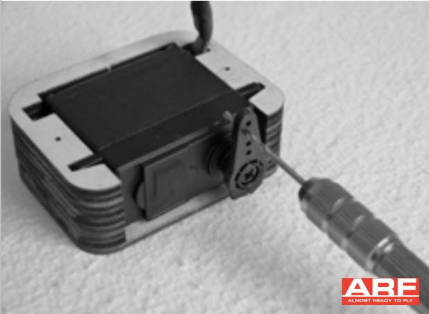
Die nicht benötigte Seite des Servohorns abkneifen. Das 2. Loch von außen auf etwa 1,6mm aufbohren.
