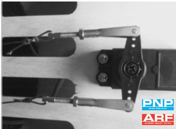
Die Augenschraube von hinten durch den Rumpf fädeln und einen Gabelkopf aufdrehen. In das äußerste Loch des Servos einhängen.
