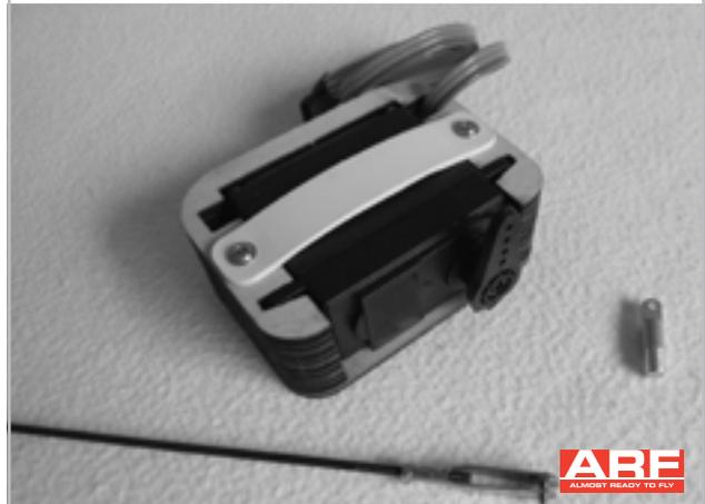
Mit einem Servotester das Servo auf Mitte stellen. Geben Sie nun wenig Schraubensicherung auf die Servoschraube und schrauben Sie den Servohebel rechtwinklig auf. Die nicht benötigte Seite abschneiden. Schrauben Sie das Servo in den Rahmen. Schrauben Sie eine Mutter und dann den Gabelkopf etwa zur Hälfte auf das Gestänge auf.
