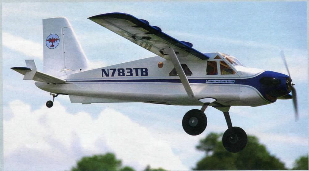
Die Bushmaster beim zweiten Flug: Da der Motor in der schmalen und relativ langen Turbo-Schnauze überhitzt, wird der Spinner entfernt und es kann ungestraft „geheizt“ werden
