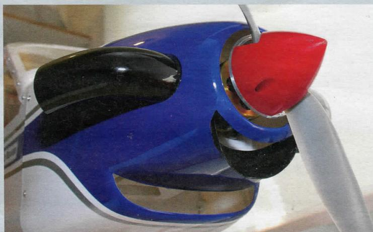
Die Lösung des Kühlproblems: Eine Lüftungsöffnung ganz vorne in der Schnauze mit einem kleinen Luftleitblech
