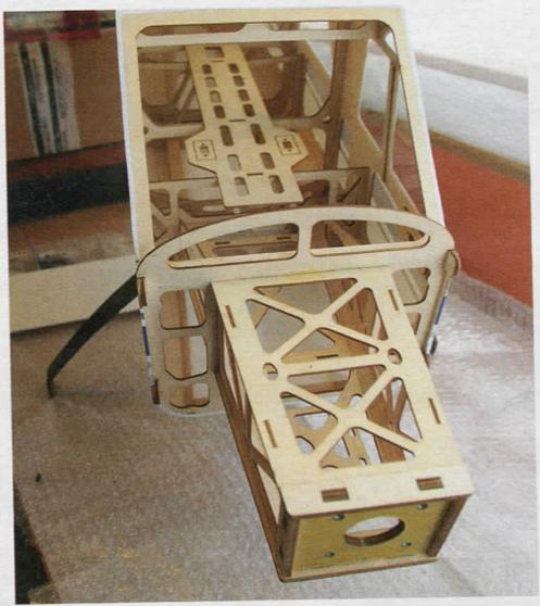
Extreme Leichtbauweise: Die Seitenwände des Motordoms ragen bis weit in den Rumpf hinein und werden zur Fahrwerksaufnahme abgestützt
