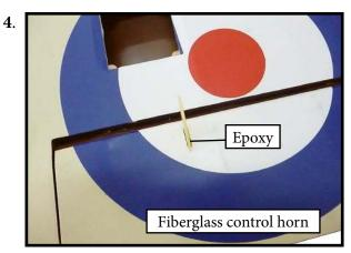
INSTALLING THE AILERON SERVOS
