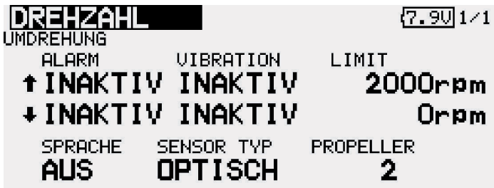
Displaydarstellung des Telemetrie Monitor und Sensormenüs im Sender FX-32
