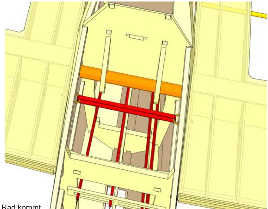
**75** Zum Schluss wird der Bergfalke mit Gewebe oder Folie bespannt (nicht im Lieferumfang enthalten). Das Querruder wird mit der Bespannung mit der Tragfläche verbunden. Das Seiten- und Höhenruder wird mit den Scharnieren mit 2K-Kleber mit dem Leitwerk verklebt. Das Rad wird mit der Achse L30 in Radkasten eingesetzt und durch die gebogenen Klammer gehalten.
