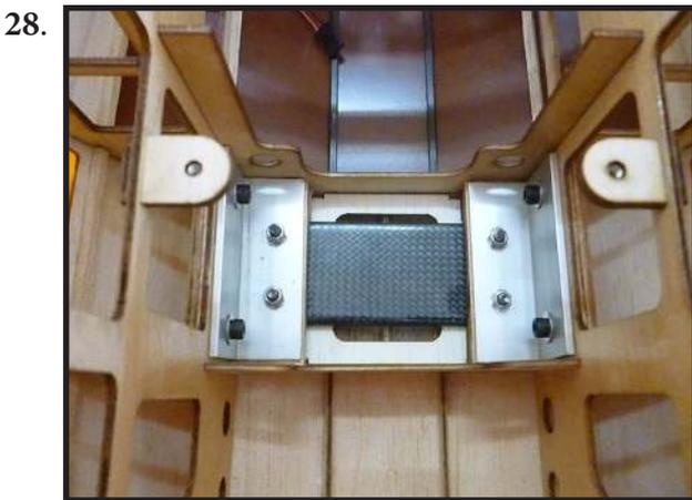
**INSTALLING THE RECEIVER SWITCH**
