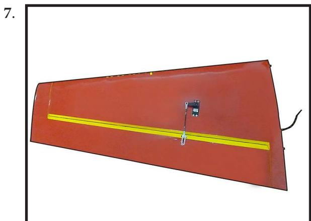
**INSTALL HINGE FOR STABILIZER AND ELEVATOR**
