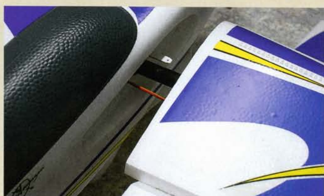
So einfach wird die zweigeteilte Tragfläche an den Rumpf gesteckt: Das hochwertige Kohlefaserrohr sowie eine Kunststoffarretierung je Seite halten den Flügel sicher am Rumpf fest
