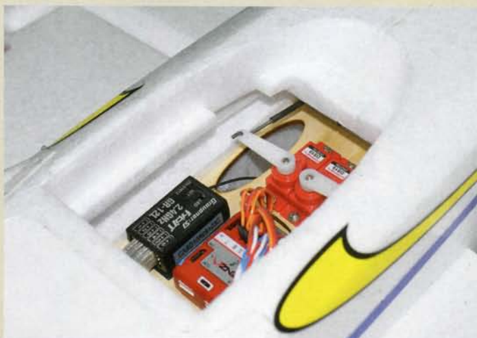
Das groß gestaltete „Empfänger-Fach“ samt Regler befindet sich unterhalb des Rumpfes
