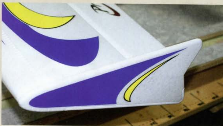
Die Side-Force-Generatoren bringen eine fühlbare Flugstabilität im Harrier mit sich und werden einfach in die Tragflächen gesteckt
