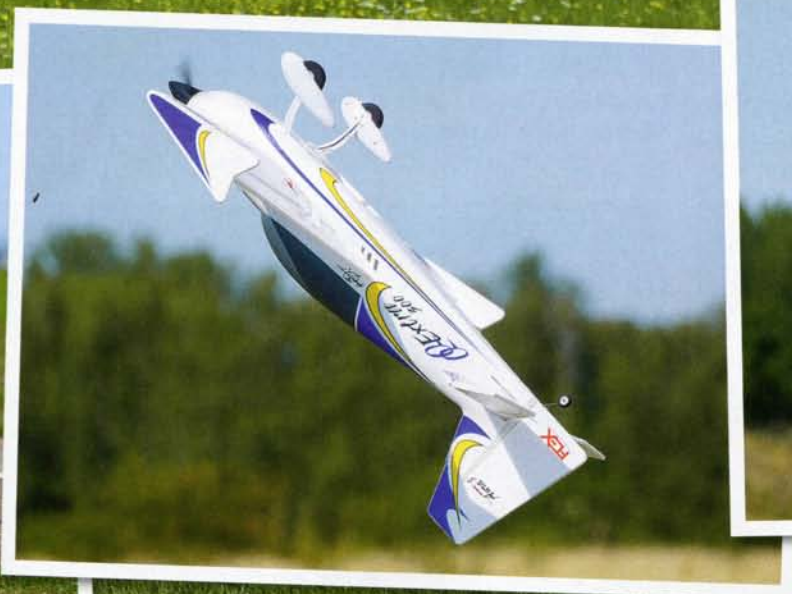
Im Rückenharrier stabilisiert sich das Modell dank angebrachten SFGs ohne Flächenwackeln
