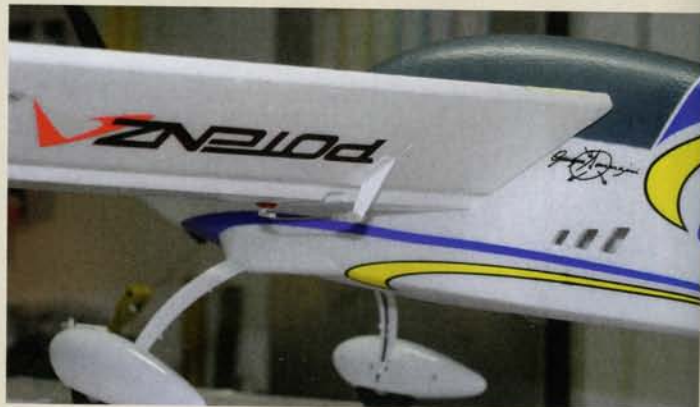
Hochwertige Ruderhörner aus ABS-Kunststoff sorgen für absolute Stellpräzision der eingebauten Digitalservos von Potenza
