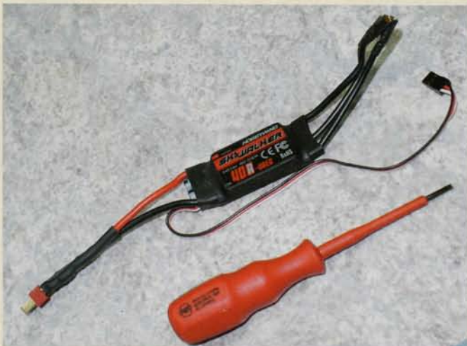
Der 40-Ampere-Skywalker-Regler von Hobbywing im Detail: Den T-Stecker haben wir wegen unseres Akkusystems am Regler verlötet
