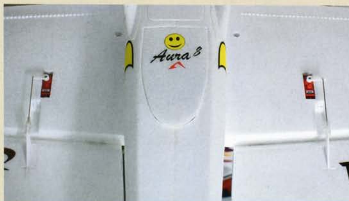
Die kleinen Aussparungen in der Fläche an den Querruder-Ruderhörnern sind notwendig, um einen maximalen 3D-Ausschlag ohne mechanische Begrenzung zu erzielen
