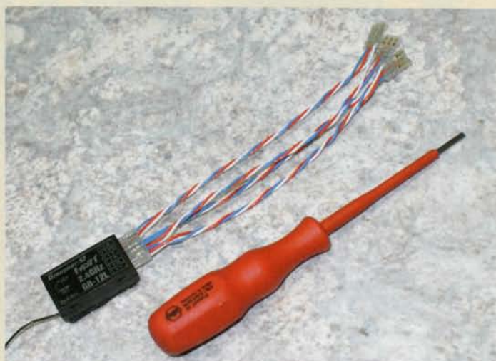
Schraubenzieherlange Patchkabel müssen beim PPM-Verfahren vom Kunden noch selbst hergestellt werden
