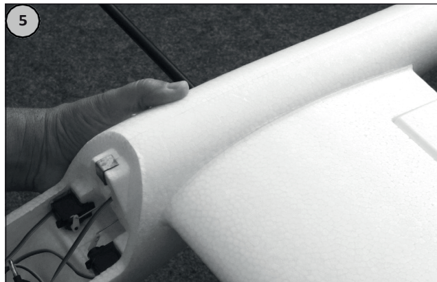
Figures 4 et 5: Glissez l'aile dans l'évidement du fuselage. Tirez avec précaution le câble de raccordement à travers l'évidement situé au milieu du fuselage jusqu'à l'avant du fuselage.
