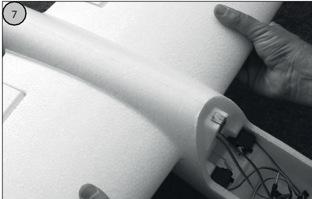
Figure 7: Poussez et joindre maintenant les ailes complètement ensemble.
