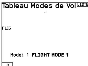
Dans le menu mode de vol, vous pouvez programmer jusqu'à 10 modes de vols et les assigner à n'importe quel interrupteur ou combinaison d'interrupteurs en utilisant jusqu'à 3 interrupteurs. Vous pouvez également assigner la priorité des positions des interrupteurs ou activer un mode de vol sans vous soucier de la position des autres interrupteurs.
