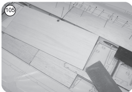
105 Obere Mittelbeplankung F 10 einpassen und mit Weissleim aufkleben, bis zum Durchtrocknen mit nadeln sichern
