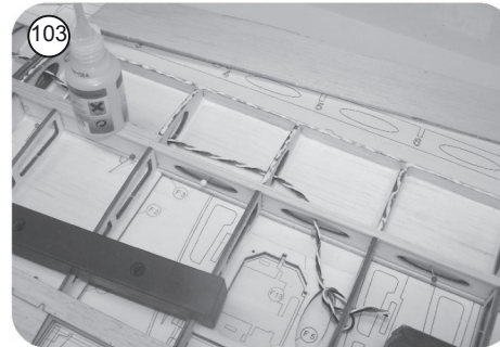
103 Obere Nasenbeplankung aufkleben, auf der Hilfsnasenleiste und den Rippen wird mit Weissleim, auf dem Holmgurt mit Sekunde. Mit Nadeln sichern.
