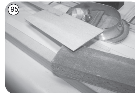
95 Obere Endbeplankung im späteren Klebebereich zur unteren Endbeplankung schräg anschleifen ( Schnitt s. Plan ). Obere Endbeplankungen mit Weissleim aufkleben und mit Nadeln sichern
