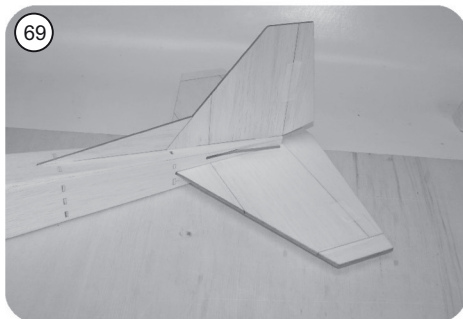
69 Leitwerke probeweise in den Rumpf einsetzen
