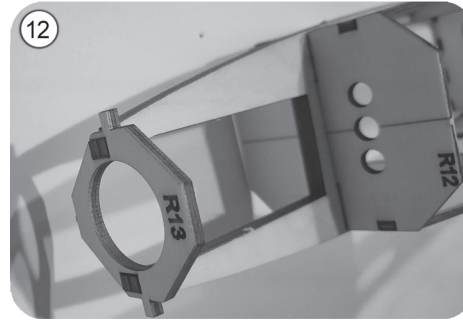
12 Spant R14 exakt 90° zu R5 einkleben.
