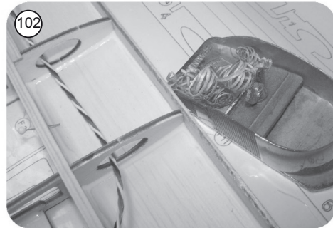
102 Hilfsnasenleiste F 7 an der Vorderkante passend zum Profilverlauf schräg hobeln
