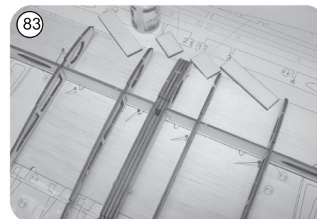
83 Kammholmverstärkungen F 4z mittig auf den Zusatzholmgurt F 3z zwischen die Rippen 2 und 3, bzw. 3 und 4 kleben
