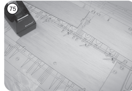
75 Untere untere Nasenbeplankungen F 1 und Mittelbeplankung F 2 von der Unterseite mit Tesafilm zusammenheften und auf dem Plan ausrichten, mit dünnem Sekundenkleber verkleben
