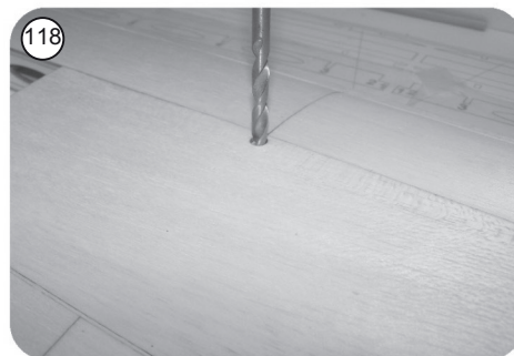
118 Bohrung für Flächenverschraubung durchbohren
