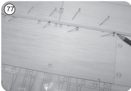
77 Holmgurte F 3 ( 5 x 2 x 445 mm ) und Zusatzholmgurt Kiefer F 3z ( 5 x 2 x 210 mm ) ablängen und auf die unteren Beplankungsteile an der hinteren Beplankungskante bündig aufkleben, Zusatzholmgurt mittig an die Vorderkante der Holmgurte aufkleben
