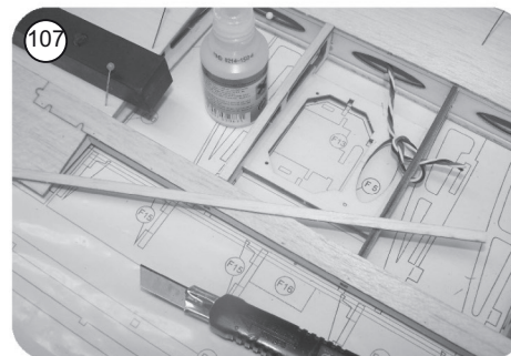
107 Rippenaufleimer oben ablängen und aufkleben
