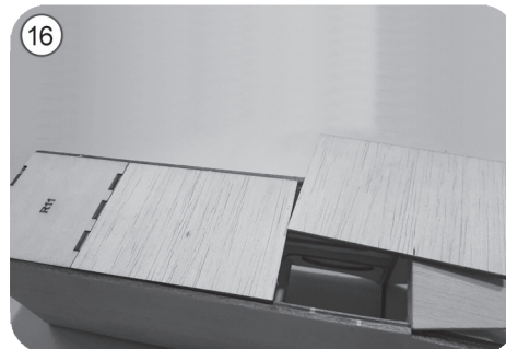
16 Weiters werden die beiden Rumpfböden R24 festkleben.
