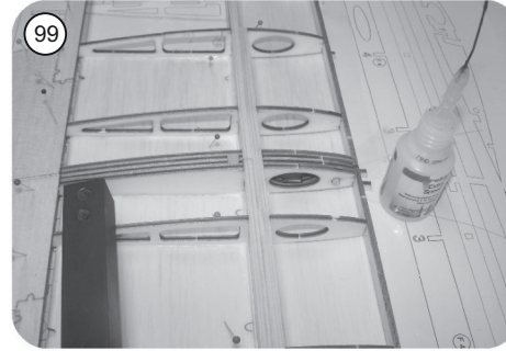
98 Untere Nasenbeplankung mit den Formkeilen an die Rippen anheben und an den Rippen und der Hilfsnasenleiste mit Sekundenkleber anheften
