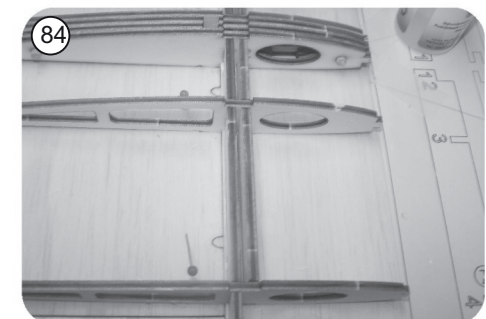
83 Kammholmverstärkungen F 4z mittig auf den Zusatzholmgurt F 3z zwischen die Rippen 2 und 3, bzw. 3 und 4 kleben
