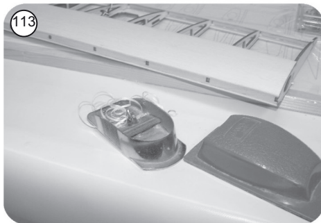
113 Beplankungsüberstand mit der Hilfsnasenleiste bündig verschleifen und Nasenleisten F 11 ankleben und mit Nadeln Fixieren
