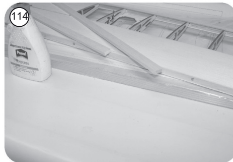
113 Beplankungsüberstand mit der Hilfsnasenleiste bündig verschleifen und Nasenleisten F 11 ankleben und mit Nadeln Fixieren
