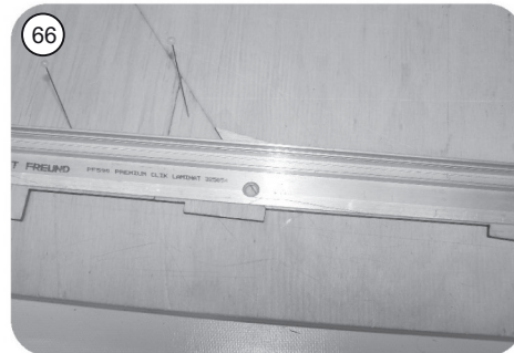
65 Beim Ankleben der Rückenfinne mit einem Lineal oder auf dem Plan ausrichten und bis zum Trocknen auf das Baubrett aufnadeln
