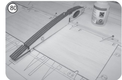
80 Rippenblock F 1/ F 2 in die Aussparungen und auf die Holmgurte aufsetzen und nur im Bereich der Holmgurte verkleben
