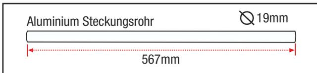
Prüfen Sie, ob sich das Aluminium Steckungsrohr leicht in die Flächenteile einführen lässt. Ggf. mit feinem Schleifpapier (240er) die Kanten der Rohre nacharbeiten bis sich das Steckungsrohr leicht einführen lässt. / Test fit the aluminium tube dihedral brace into each wing half. The brace should slide in easily. If not, use 240 grit sand around the edges and ends of the brace until it fits properly.
