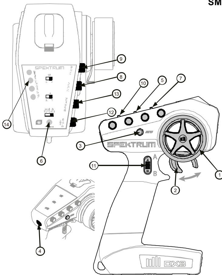
1. Steuerrad Steuert die Richtung (links/rechts) des Modells
