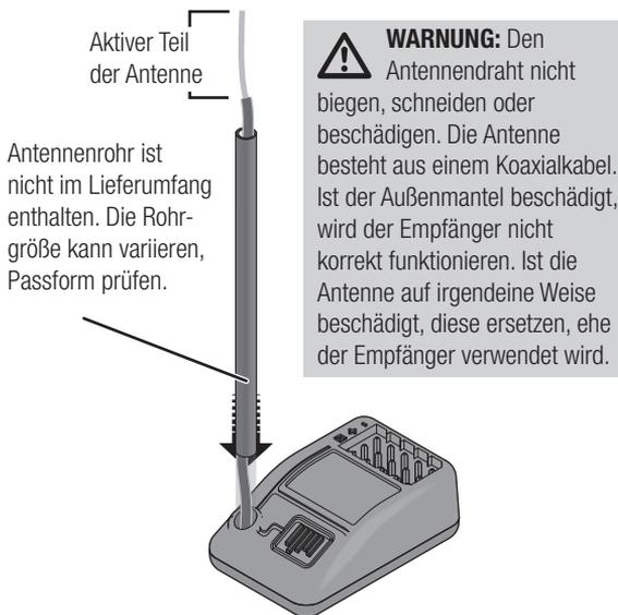
Das Gehäuse des Empfängers kann direkt ein Antennenrohr aufnehmen und ermöglicht so eine optimale und einfache Antennenplatzierung (Antennenrohr nicht im Lieferumfang enthalten).
