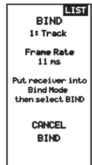
**HINWEIS:** Der Gaskanal muss in der Failsafe-Position verbleiben, bis das Binden abgeschlossen ist.
