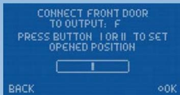
Stecken Sie das Servo für die Bugfahrwerkstüre auf Ausgang **F**. Fahren Sie mit der **SET-Taste** zuerst die vordere Fahrwerk Türe zu, im nächsten Einstellungsbildschirm die Fahrwerkstüre auf.
