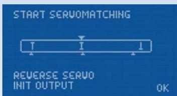
Um ein präzises Servomatching zu gewährleisten muss der einzustellende Ausgang initialisiert werden. Lassen Sie den Steuerknüppel in der Mitte. Bewegen Sie den Cursor zu **INIT OUTPUT** und drücken die **SET-Taste**. Jetzt bewegen Sie den Steuerknüppel an Ihrem Sender zu beiden Endpositionen.
