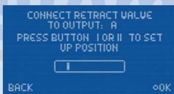
Das Fahrwerk sollte jetzt einfahren. Wenn nicht, drücken und halten Sie die **Taste I** solange, bis das Ventil schaltet und das Fahrwerk einfährt. Mit der **SET-Taste** geht es zum nächsten Einstellpunkt.
