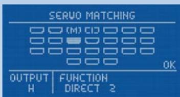
Zu sehen sind der graphisch dargestellte Ausgangsblock, die Kennung des Ausgangs und die zugeordnete Funktion des Ausgangs. Initialisierte Ausgänge sind mit einem **I** gekennzeichnet, bereits gematchte Kanäle mit einem **M**.
