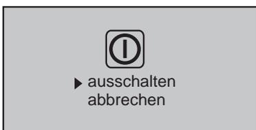
Wenn Sie die POWER Taste bei eingeschaltetem Sender länger als 2 sek drücken erscheint eine Sicherheitsabfrage (siehe Abbildung). Wählen Sie die gewünschte Option mit einem der Touch-Tastenfelder (auf oder ab) aus und drücken Sie SET.
