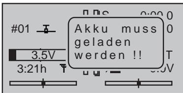
Überwachen Sie die Senderakkuspannung während des Betriebs im Display. Bei Unterschreiten einer einstellbaren Spannung, standardmäßig 3,6V, ertönt ein akustisches Warnsignal und im Display erscheint ein Fenster „Akku muss geladen werden“.
