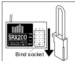
Stellen Sie das Fahrzeug auf einen ebenen Untergrund und stecken Sie den Bindestecker in den BIND Port des Empfängers.
