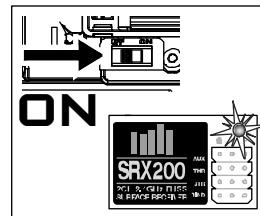
Schalten Sie den Regler ein. Die rot LED blinkt, und zeigt damit an, dass sich der Empfänger im Bindemode befindet.
