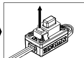
3. Um das entsprechende Parameter zu ändern, lassen Sie den Knopf bei der entsprechenden Anzahl an Blinksignalen los.
