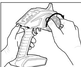
Drehen Sie das Lenkrad voll nach rechts. Halten Sie das Lenkrad in der Position und schalten den Sender ein.
