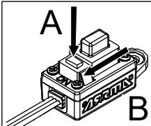
1. Brancher une batterie. Appuyez et maintenez enfoncé le bouton de réglage et allumez l' ESC. La LED rouge clignote.
