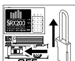
Retirez la prise d'affectation du récepteur et mettez-le hors tension pour enregistrer les paramètres.
