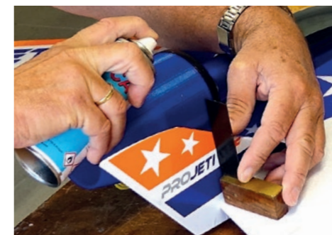
116. Leitwerk in einem Ruck einschieben, ausrichten, dann Aktivator Spray sprühen um Aushärtprozess auszulösen. / Insert the control unit in a jerk, align, then spray activator spray to initiate curing process.
