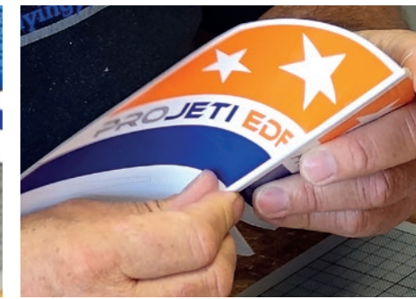
111. Darauf achten, dass die Dekorfolie zuerst am Radius angeedrückt werden muss. / Make sure that the decorative foil is first pressed against the radius.
