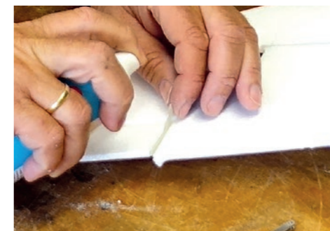
44. Ruderhorn ausrichten, dann mit Aktivator-Spray besprühen. / Align the Ruderhorn, then sprinkle with activator spray.
