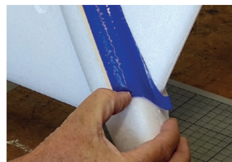
9. Eingeschnittene Dekorfolie wird in Nute gedrückt. / Cut-in decorative foil is pressed into groove.
