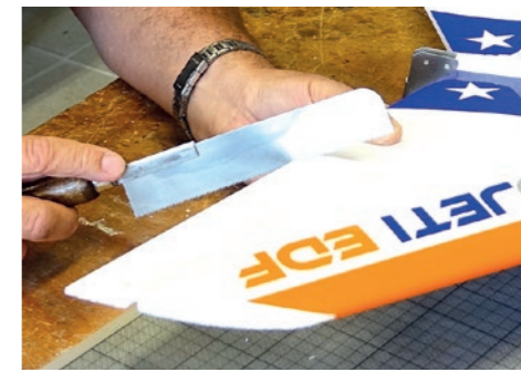
38. Querruder auftrennen, darauf achten, dass die Markierung der Startstellung am Flügel erhalten bleibt. / Disconnect the aileron, make sure that the marking of the start position on the wing is maintained.
