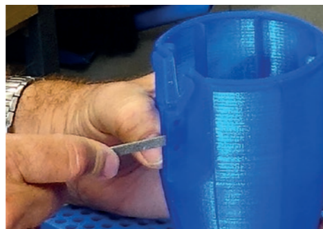
59. Schlitz mit Feile plan zur Seitenfläche ausfeilen. / Cut the slit with the file flat to the side surface.
