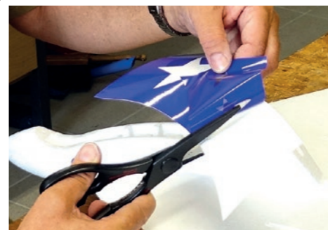
13. Trägerpapier nur ca. 1/3 abschneiden, damit Dekorteil ausgerichtet werden kann. / Cut the backing paper only approximately 1/3 so that the decorative part can be aligned.
