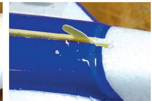
72. Schlitz wird mit Bals-Messer erstellt wie abgebildet. / Slot is created with bals-knife as shown.
