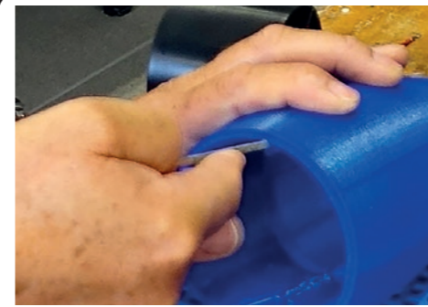
61. Rechts vom Steg Einschiebe-Kerbe frei feilen. / To the right of the bridge, insert the insertion slot free.
