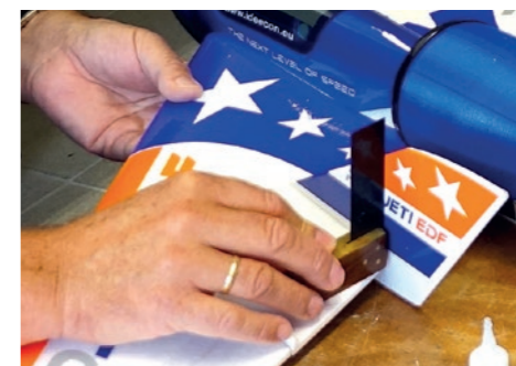
119. Winkel am anderen Leitwerk an gleicher Stelle anlegen, dann passt es! / Place the angle on the other tail in the same place, then it fits!
