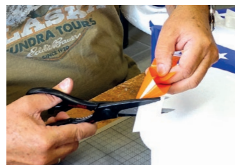
19. 1/3 der Trägerfolie wird abgezogen um die Versteifung ausrichten und aufkleben zu können. / 1/3 of the carrier film is peeled off in order to be able to align and stick the stiffener.
