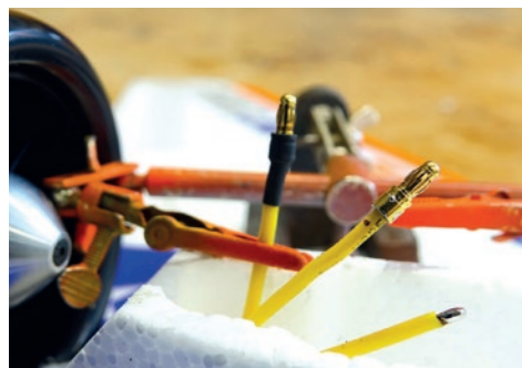
82. Motor-Kabel werden beiliegenden Stecker verlötet und verschumpft. / Motor cables are soldered and shrunk.
