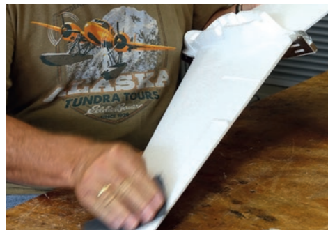
1. Mit 400er Schleifpapier werden Dampfzulen abgeschliffen. / Steam nozzles are sanded with 400 abrasive paper.
