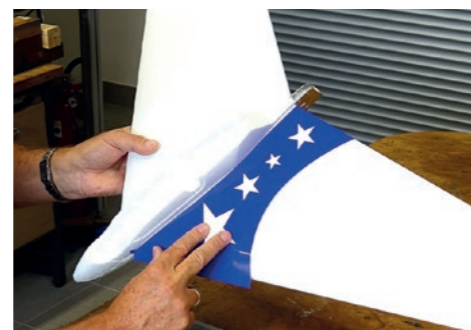
12. Dekor wird an der Endleiste bündig mit Schutzpapier zur Überprüfung angelegt. Achtung: Die Nute an der Rumpfwand darf nicht überklebt werden! / Decor is applied to the end strip flush with protective paper for inspection. Attention: The groove on the hull wall must not be covered!
