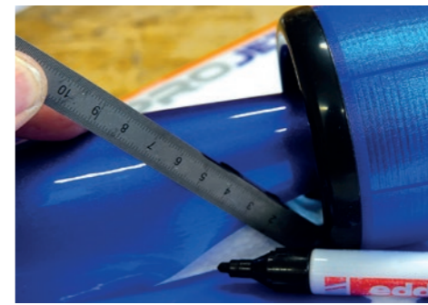
86. Übernahme der Kontur des Schaumlings. / Take over the contour of the foam.
