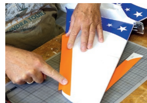
20. Das Folienteil so aufkleben, dass der Nasenradius umklebt werden kann. / Glue the foil part so that the nose radius can be glued.
