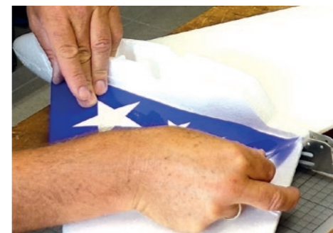
14. Ausrichten des Dekor und ankleben bündig zur Endkante. / Align the decor and glue flush to the end edge.
