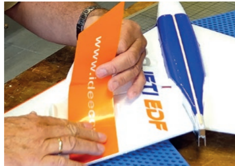
53. Dekorteil ausrichten und an der Hinterkante bündig ankleben. / Align the decorative part and glue it flush at the rear edge.
