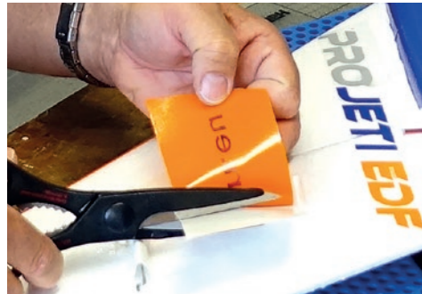
52. Dekorteil Trägerfolie ca. 1/3 abschneiden. / Decant the carrier foil approx. 1/3.
