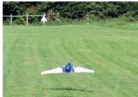
129. Nach ca. 15m Start-Strecke hebt Projeti EDF bei Windstille ab und beschleunigt kontinuierlich. / After about 15 m Projeti EDF takes off and accelerates continually.
