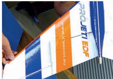
56. Dekorierte Flügel-Unterseite zur guten Fluglageerkennung. / Decorated wing underside for good flight position detection.
