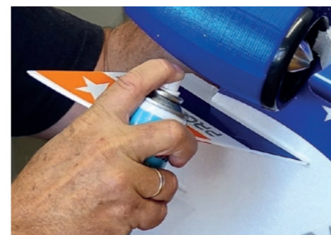
118. ... dann mit Aktivator-Spray aushärten. / ... then cure with activator spray.
