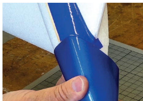
11. ... und zeigt wie Folie im Absatz unter die Haube geht. / ... and shows how foil in the paragrah goes under the hood.
