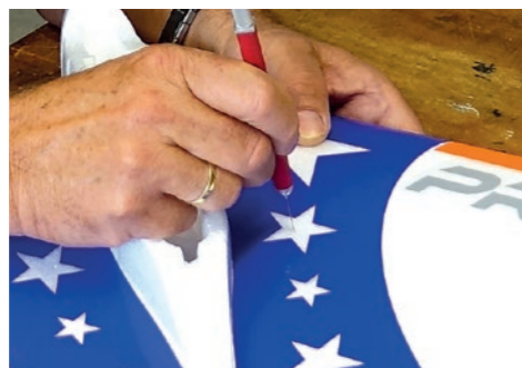
32. Folie an Schwerpunkt-Bohrung durchstechen. / Slide through center of gravity hole.
