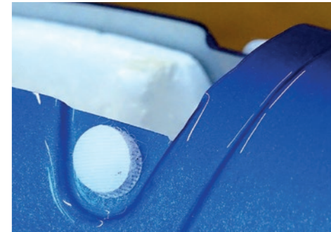
90. A. Klettchen für Kabinenhaube am Rumpfrücken ankleben. / A. Glue the Velcro panels for the hood panel to the back of the fuselage.
