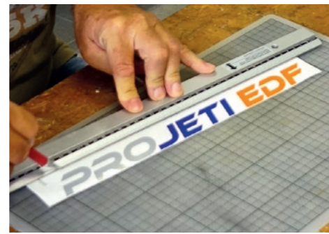
27. Projeti EDF Schriftzug so ausschneiden, dass über dem Schriftzug ca. 1 cm breite transparente Folie vorhanden ist. / Cut Projeti EDF lettering so that over the lettering is about 1 cm wide transparent film is present.
