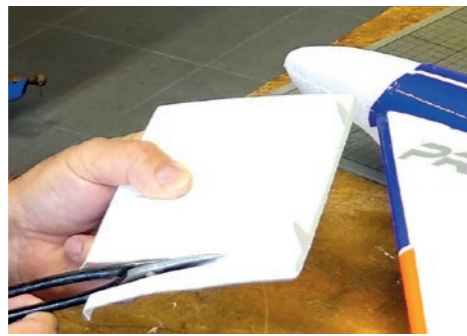
50. Servo-Abdeckungen ausschneiden und einpassen. / Cut and adjust servo covers.
