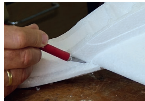
3. Abtrennen des Schaumüberstands mit Balsamesser. / Remove the foam supernatant using a Balsa knife.
