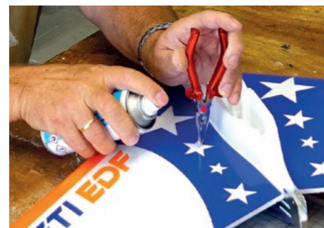
33. Schwerpunkt-Dreiecke mit Sek.-Kleber einkleben. / Glue the center of gravity triangle with sec-adhesive.
