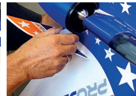
117. Zusätzlich fein dosiert an Klebestelle Sek.-Kleber aufbringen ... / Carefully apply some glue into the rim ...
