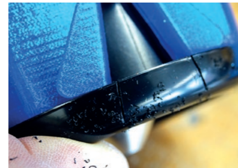
67. Einlauflippe aufstecken und wie abgebildet aufsägen. / Insert the inlet lip and sew as shown.
