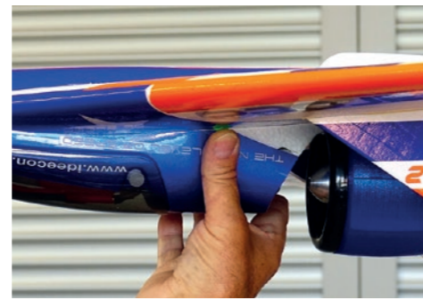
123. Schwerpunkt wird in Rückenlage über die Schwerpunkt-Pfeile eingestellt. / Center of gravity is adjusted in the back position by means of the center of gravity arrows.
