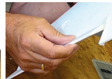
45. Querruder auf Leichtgängigkeit prüfen. / Check the ailerons for smooth operation.
