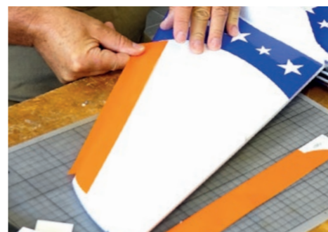
22. Folienteil ausrichten und aufkleben. / Align and glue the foil.
