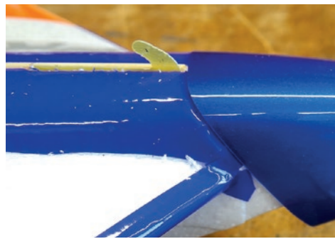
73. Vor Verklebung sollte exakte Position mit Tiefzieh-Nase überprüft werden. / Before gluing, exact position with deep drawing nose should be checked.
