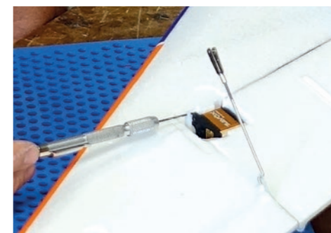
47. Loch am Servo-Ruderhorn ggf. auf 1,5 mm aufbohren. / If necessary, drill the hole on the servo-rudderhorn to 1.5 mm.
