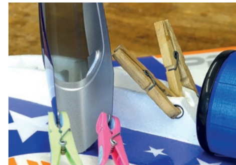
93. Klebescheiben über Nacht mit Klammern andrücken bis Kleber aushärtet. / Press on the glue discs overnight with adhesive until the glue hardens.
