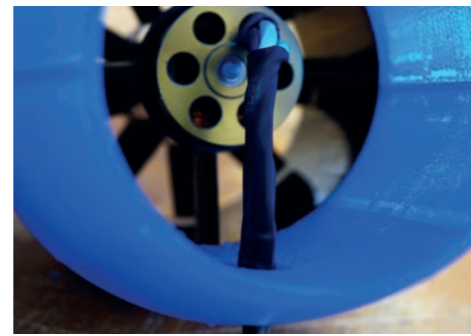
75. Kabelverlegung durch Durchführungsöffnung. / Cable routing through feedthrough.
