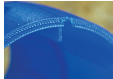
64. Zeigt Impeller-Gehäuse mit ausgefeiltem Führungsschlitz. / Displays impeller housing with a sophisticated guide slot.
