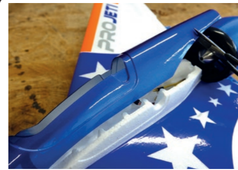
85. Abdeckung Rumpfrücken wird mit Schere auf Schaumlänge gekürzt. / Cover Rump backs are shortened with scissors to foam length.
