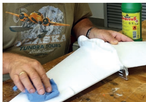
4. Reinigen der Oberfläche mit weichem Tuch und Spiritus. / Clean the surface with soft cloth and alcohol.
