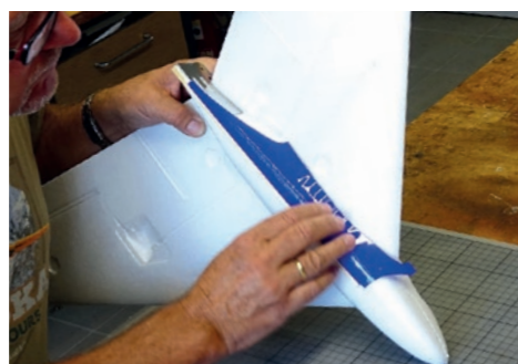
8. Dekorteile werden an Kufer angesetzt und dann angedrückt. / Decorative parts are attached to the skids and then pressed.
