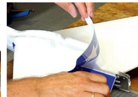
15. Abziehen der vorderen Trägerfolie. Achtung: Die Nut darf nicht überklebt werden, die transparente Fläche des 2. Sterns (von vorne) muss sich über Schwerpunkt-Loch befinden! / Pull off the front carrier film. Caution: The groove must not be covered, the transparent surface of the 2nd star (from the front) must be above the center hole!
