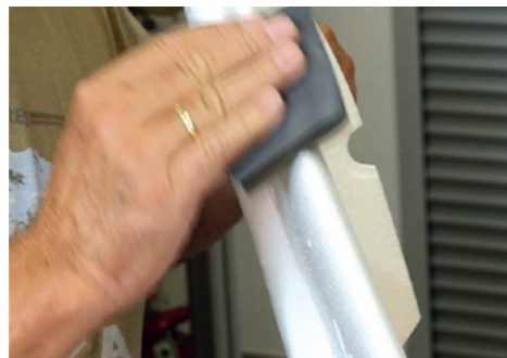
2. Nasenradius wird ebenfalls leicht überschliffen. / Nose radius is also easily sanded.
