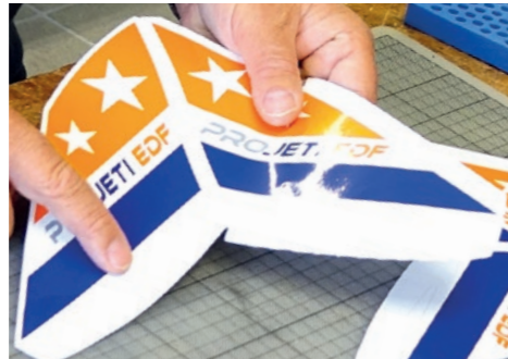
101. Achtung: Dekorfolie nur die Umrisse ausschneiden. Keile nicht ausschneiden! / Caution: decor foil only cut out the outline. Do not cut the wedges!
