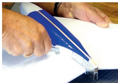
35. Rumpf-Durchbruch für Servo-Kabel mit einem angeschliffenen Alu-Rohr herstellen. / Fuselage breakthrough for servo cables with a ground aluminum tube.
