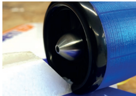
80. Einlaufklappe muss leichtgängig aufgeschoben werden können. / The inlet lip must be easily pushed open.
