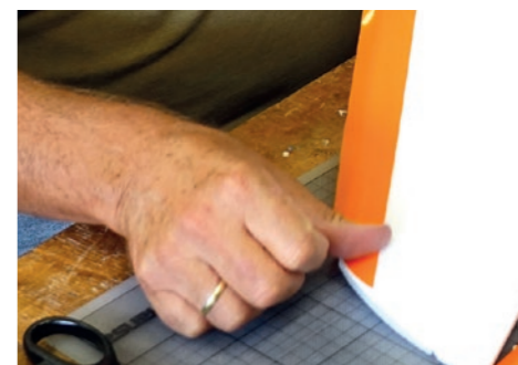
23. Mit dem Daumen die Folie um den Nasenkreis aufrücken. / Use the thumb to press the film around the nasal circle.
