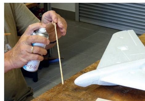
6. Holzkufer mit Aktivator einsprühen, Sek.-Kleber in Schaumnute, dann Kufer in Nute einkleben. / Spray the wooden cake with the activator, glue the glue in the foam groove, then the curve in the groove.
