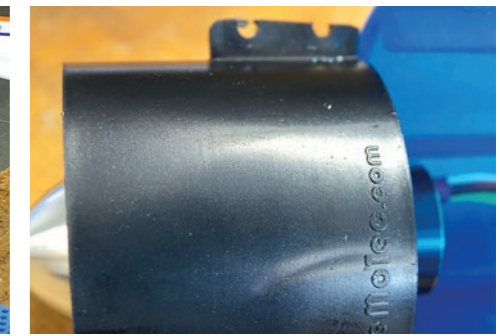
63. Zeigt Impeller-Gehäuse mit dem richtig abgeschnittenen Aufnahme-Flansch. Achtung: Es muss der Flansch sein wo die Schrift endet! / Shows the impeller housing with the correctly cut receiving flange. Attention: It must be the flange where the font ends!
