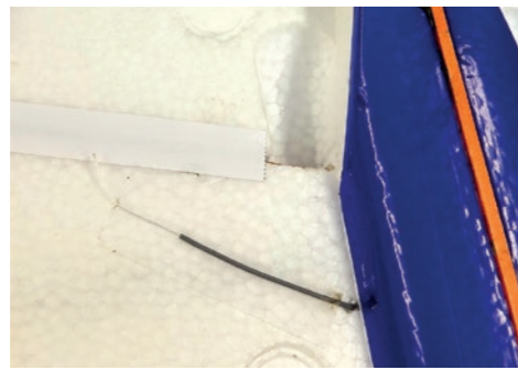
122. Für die 2. Antenne wird individuell ein Durchbruch angefertigt und diese durchgeführt. / A breakthrough is individually made for the second antenna and this is carried out.
