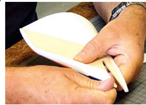
109. Umschläge faltenfrei über Nasenradius ankleben. / Fold the envelopes over the nose radius without wrinkles.
