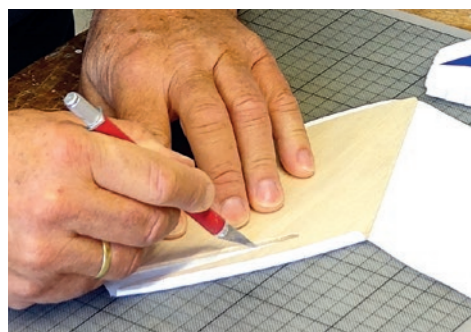
106. Keile am Balsarand ausschneiden. / Cut the wedges on the balsar.
