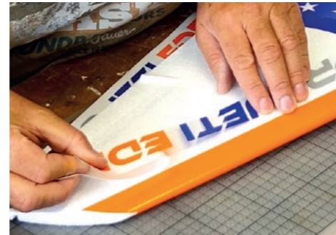
30. Trägerfolie stückweise abziehen und Dekor aufkleben. / Carefully peel the backing film and glue the decor.
