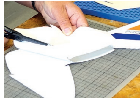
102. Schutzfolie Nur zur Hälfte trennen, an der Seite wo Folien Überlappungen sind. / Protective film Only cut in half, on the side where films are overlapping.
