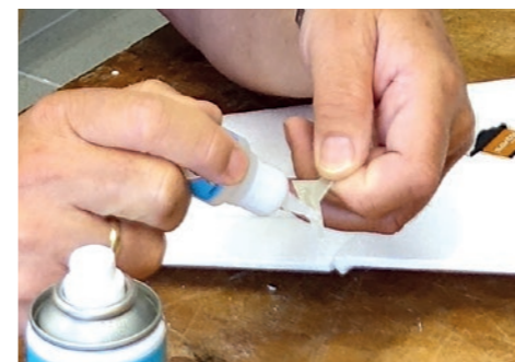
43. GFK-Ruderhörner an Klebefläche mit Sek.-Kleber bestreichen. / Apply GFR rowing horn to adhesive surface with sec-adhesive.
