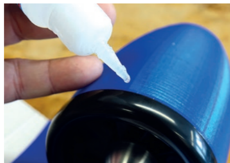
83. Nach dem Probelauf des Impellers, die Einlasslippe mit einem Tropfen Sekundenkleber sichern. / After the test run of the impeller, the inlet lip is fixed with a drop of Sec. Glue.
