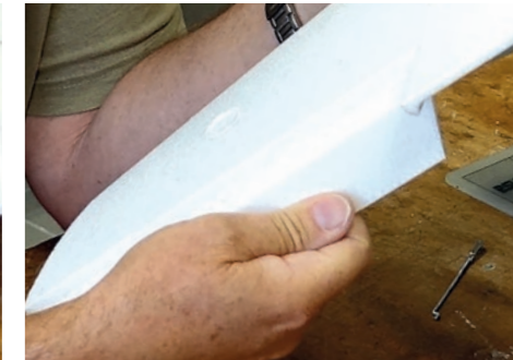
42. Querruder bis max. 90° schwenken und leichtgängig machen. / Ailerons up to max. 90° and make it light.
