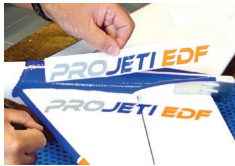
49. Dekorsatz wie abgebildet ausschneiden, damit die Einschäumer-Vertiefungen überklebt werden können. / Cut out the decoration set as shown, so that the skimmer recesses can be covered.
