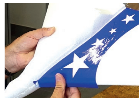
17. Überstehende Folie wird um den Nasenradius geklebt. / Overlying film is glued around the nose radius.
