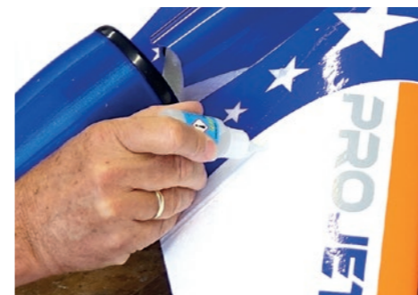
115. Sek.-Kleber in Führungsschlitz (Nut) auftragen. / Apply glue to the mounting slot.
