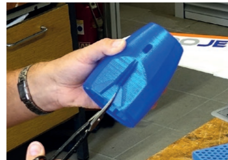
57. Impeller-Gondel im abgebildeten Bereich ausschneiden. / Cut the impeller gondola in the area shown.
