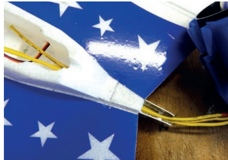
76. Motor-Kabel werden durch Kabeltunnel geführt. / Motor cables are routed through cable ducts.
