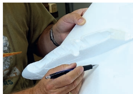
5. Position der Schwerpunkt-Löcher für GFK-Schwerpunkt-Pfeile. / Position of the center of gravity holes for GRP center of gravity arrows.
