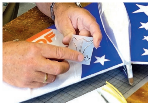
31. Schwerpunkt-Dreiecke aus GFK-Fräsplatte ausbrechen. / Break the trunk triangles from the GFR milling disc.
