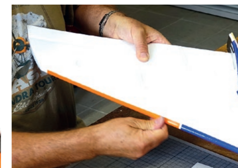
24. Unterseite zeigt den Folienumschlag. / Bottom shows the foil envelope.
