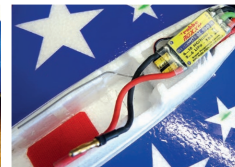
120. Empfänger wird unter Regler eingebaut. Antenne laut RC-Herstellerangabe verlegen! / Receiver is installed under controller. Connect the antenna according to the RC manufacturer's instructions!
