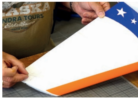
25. Die transparenten Folienteile werden als Scharnierfolie aufgeklebt. / The transparent film parts are glued as hinge films.
