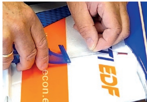
55. Offene Stelle des Servokanal mit Tape abkleben. / Wipe the open position of the servo channel with tape.
