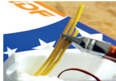
81. Motor-Kabel werden wie abgebildet gekürzt. / The motor cable must be shortened as shown.
