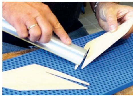
98. A. Balsa-Seitenleitwerke werden ausgetrennt und mit Radien versehen. / A. Balsa side fins are separated and provided with radii.
