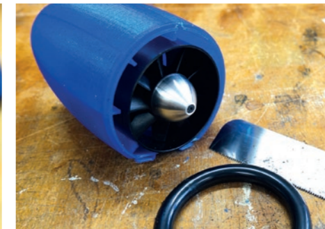
68. Impeller mit aufgesägter Einlauflippe. / Impeller with raised inlet lip.
