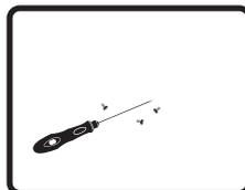
Die Karosserie auf lose Schrauben überprüfen, insbesondere die Schrauben für Achsschenkel, C-Naben und Achsausgänge
