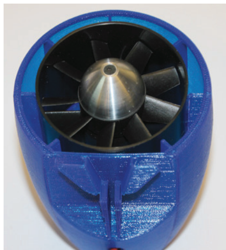
Äußerst passgenau ist die Triebwerksgondel, der Wemotec-Impeller passt saugend hinein.
