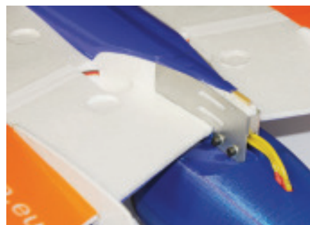
Die Triebwerksgondel wird auf einem Aluhalter verschraubt und liegt nur knapp über der Fläche. Die enthaltenen Schrauben habe ich gegen Inbusschrauben getauscht, da man mit einem normalen Schraubendreher nur schwer an die Stelle herankommt.
