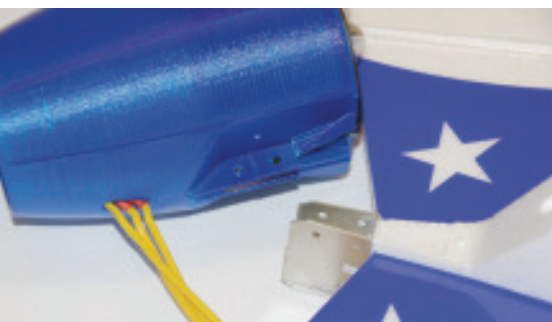
Die Triebwerksgondel wird auf einem Aluhalter verschraubt und liegt nur knapp über der Fläche. Die enthaltenen Schrauben habe ich gegen Inbusschrauben getauscht, da man mit einem normalen Schraubendreher nur schwer an die Stelle herankommt.
