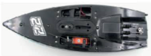
Vormontierter Rumpf mit Servos, Empfänger und Batteriebox
