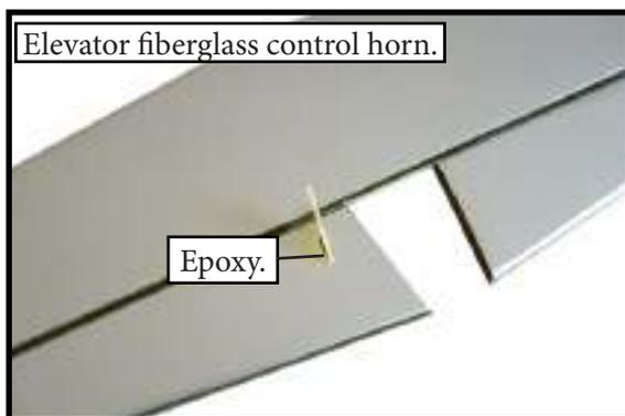
**INSTALLING THE HORIZONTAL STABILIZER.**
