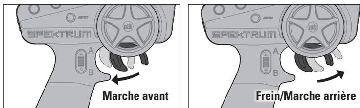
4. Tirez le déclencheur de l'émetteur sur plein gaz, arrêtez, puis remettez le déclencheur au centre.
