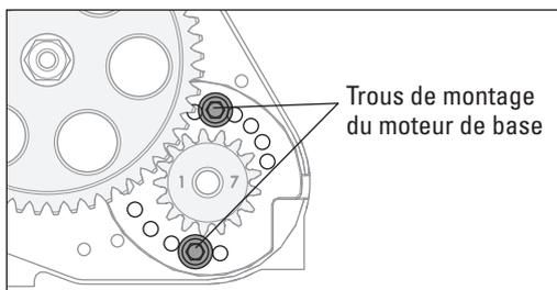
Le réglage de l'engrènement n'est nécessaire que lors du changement des engrenages.
