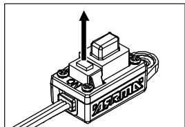
3. Um das entsprechende Parameter zu ändern, lassen Sie den Knopf bei der entsprechenden Anzahl an Blinksignalen los.
