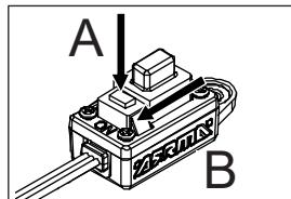
1. Verbinden Sie den Akku. Drücken und halten Sie den Set-Knopf und schalten Sie den Regler ein. Die rote LED wird blinken.
