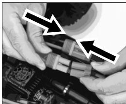
Schließen Sie einen vollständig geladenen Akku an den Regler an.
