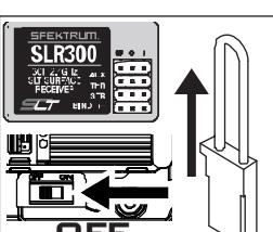
Retirez la prise d'affectation du récepteur et mettez-le hors tension pour enregistrer les paramètres.
