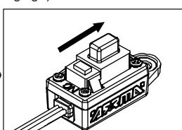
5. Pour enregistrer le réglage, mettez l'ESC hors tension. Redémarrez le processus pour faire d'autres modifications de réglages
