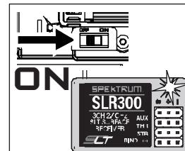
Mettez le contrôleur sous tension. La DEL rouge clignote indiquant que le récepteur est en mode affectation.
