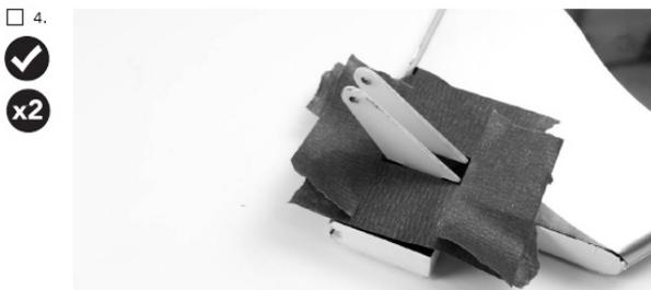
Passen Sie die Ruderhörner in die entsprechenden Schlitze ein. Nehmen Sie Anpassungen an den Schlitzen vor, wenn notwendig. Kleben Sie die Stellen rund um die Schlitze mit leicht klebendem Klebeband im Abstand von ca. 1 mm ab. Bei Verwendung einer Doppel Ruderanlenkung muss das auf beiden Seiten erfolgen. Nach dem Anbringen des Klebebandes, entfernen Sie die Ruderhörner aus den Schlitzen.
