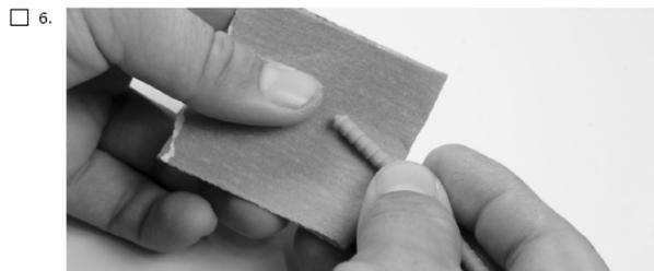
Schleifen Sie die Klebefläche des Scharniers mit Schleifpapier mittlerer Körnung an. Benutzen Sie ein Papiertuch um Isopropyl Alkohol um die Klebefläche zu säubern. Entfernen Sie Rückstände vom Scharnier. Nur wenn die Scharniere richtig angeschliffen worden sind kommt eine haltbare Verklebung zustande.
