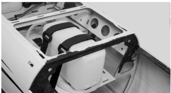
Ziehen Sie die Entlüftungsleitung hinter dem Kraftstofftank entlang nach vorne und lassen Sie sie vor dem Tank auf der Unterseite des Rumpfs austreten. Befestigen Sie sie mit einer Methode Ihrer Wahl. Bringen Sie die „T“ Verbindung, die Füllleitung an die gleiche Stelle wie die Entlüftungsleitung. Die Füllleitung muss nicht um den Kraftstofftank gewickelt werden, sie wird mit einem Stopfen verschlossen, der nur entfernt wird, wenn Sprit eingefüllt werden soll.
