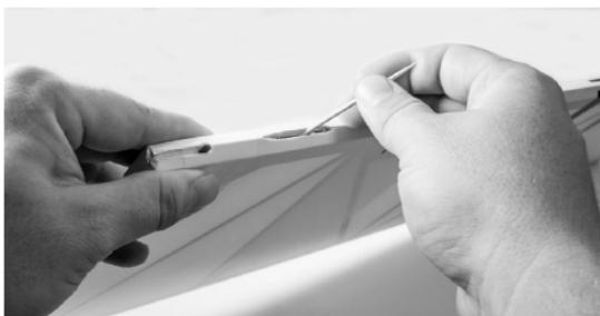
Mischen Sie eine ausreichende Menge 30 Min. Epoxy in einem geeigneten Behälter an. Mit einem Zahnstocher, schmieren Sie das Epoxy in die Schlitz der Ruderhörner. Langsam und vorsichtig setzen Sie die Ruderhörner ein. Gehen Sie wie bei den anderen Ruderhornmontagen vor.
