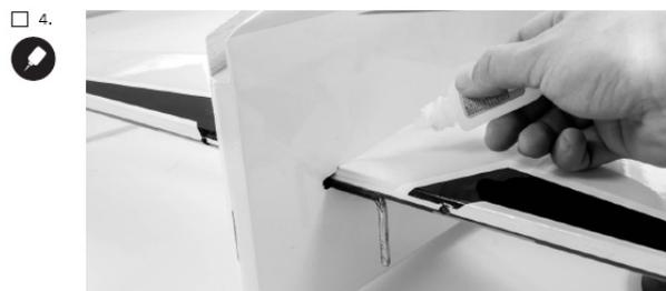
Nach der Ausrichtung des Höhenleitwerks kleben Sie vorsichtig mit dünnflüssigem CA Kleber zuerst die Oberseite und nach dem Trocknen die Unterseite des Leitwerks fest.
