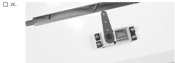
Schalten Sie den Sender ein, bringen Sie die Trimmungen und Neutralstellungen auf die Mittelposition und setzen Sie einen 32 mm Servohebel auf das Servo, der genau rechtwinklig zu den Servolängsseiten stehen muss.
