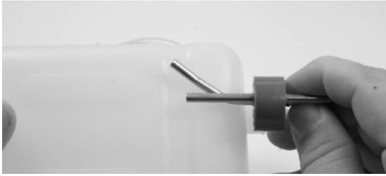
Verwenden Sie eine Zange, erfassen Sie eines der Rohre auf der Rückseite des Stopfens, und biegen Sie eine kleine Biegung ins Rohr, wie auf dem Foto gezeigt. Dies wird das Entlüftungsröhrchen des Kraftstoffsystems, es sollte sehr nahe der Oberseite des Tanks liegen, damit möglich viel Sprit in den Tank passt. Messen Sie die Biegung, indem Sie die Einheit richtig positioniert an den Tank halten. Sie können dieses Stück auch verlängern mit einem kurzen Stück Benzin Kraftstoffschlauch.
