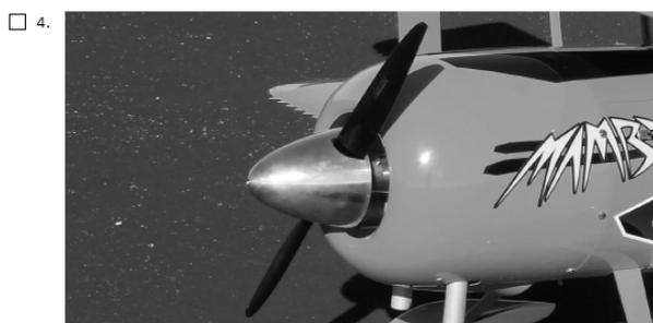
Bringen Sie jetzt den Spinner und die Luftschraube an. Für einen DA-70 empfehlen wir einen 24 x 9" Carbon Luftschraube und einen 5 Zoll Aluminium Spinner.
