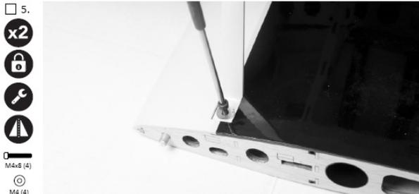
Legen Sie das Flugzeug umgedreht auf Ihren Arbeitstisch, so dass die Oberseiten der Streben zugänglich sind. Verwenden Sie einen 3 mm Kugelkopf Schraubendreher, um eine M4 x 8 Inbusschraube und eine M4 Unterlegscheibe durch die Strebe in die Einschlagmuttern in den Flächen zu schrauben. Ziehen Sie die Schrauben fest.
