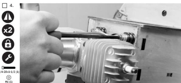
Montieren Sie den Motor am Motorspant mit den 15 mm Schwingungsdämpfern. Nehmen Sie Inbusschrauben
