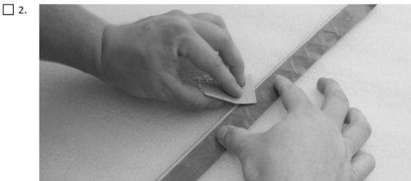
Sichern Sie mit leicht klebendem Klebeband die Haifischzahn Streifen, so dass nur der Bereich, der in die Tragfläche geklebt wird freigelegt verläuft. Verwenden Sie ein feinkörniges Schleifpapier, um beide Seiten dieses Bereichs anzuschleifen.
