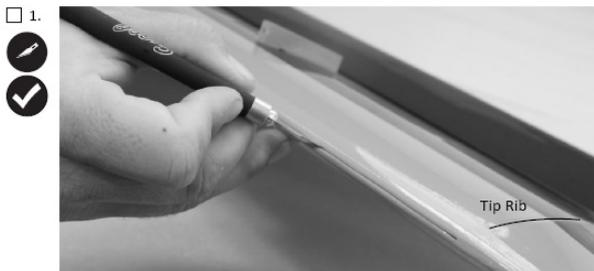
Lokalisieren Sie Schlitz in der Vorderkante der Tragfläche von der äußeren Rippe kurz vor der Verjüngung an der Spitze der Fläche. Jeder Schlitz ist ca. 300 mm lang, von der äußeren Rippe her. Verwenden Sie ein Klammernmesser, um die Schlitz an der Vorderkante einer jeden Fläche zu öffnen. Prüfen Sie ob die Haifischzahn Streifen in die Schlitz passen. Stellen Sie sicher, dass alles passt und richtig ausgerichtet ist.
