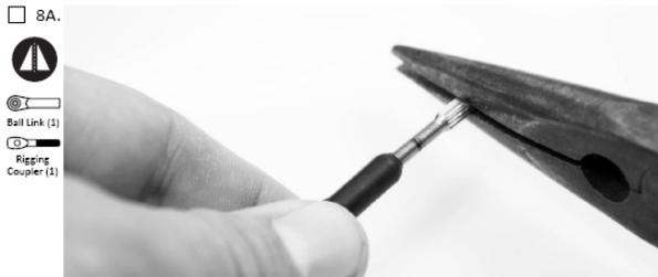
Mit Hilfe einer Zange drehen Sie das Gewinde der Ringöse etwa bis zur Mitte in den Kugelkopf ein.
