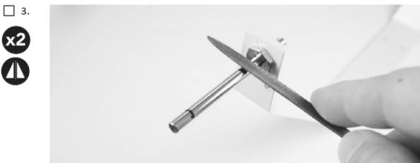
Feilen Sie mit einer Flachfeile an den Markierungsflächen auf die Achse, damit die Schrauben sicher halten.
