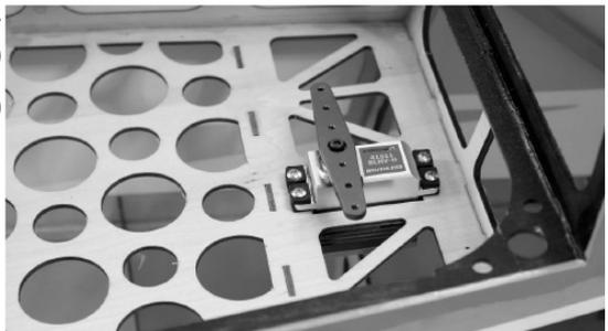
Schalten Sie den Sender ein, bringen Sie die Trimmungen und Neutralstellungen auf die Mittelposition und setzen Sie einen zweiseitigen 64 mm Servohebel auf das Servo, der genau rechtwinklig zu den Servolängsseiten stehen muss.
