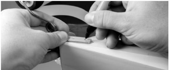
Bringen Sie die Halterung in die richtige Position, symmetrisch zur aufgezeichneten Mittellinie und markieren Sie die beiden Löcher mit einem Stift.
