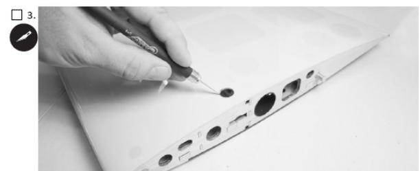
Suchen Sie die Löcher für die Flügelschrauben auf der Oberseite des Flächenmittelteils. Entfernen Sie die Abdeckung mit einem Klingmesser Klinge, wobei Sie ca. 3 mm stehen lassen. Verwenden Sie ein abgedecktes Folieneisen, um mit den Überständen das Loch zu versiegeln. Achten Sie darauf, dass Sie die richtigen Löcher benutzen, da es andere ähnliche Löcher in der Oberseite der Flächen gibt.
