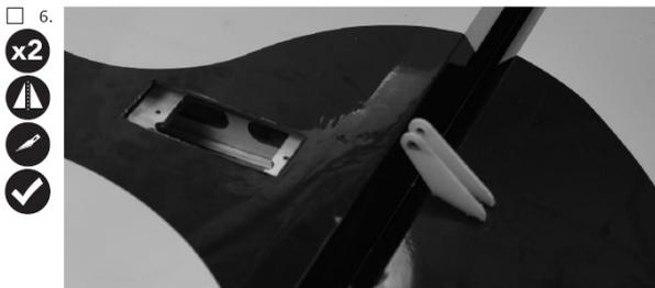
Suchen Sie die Ruderhorn Schlitze in den Querrudern, entfernen Sie die Abdeckung von den Schlitzen mit einem Hobbymesser. Überprüfen Sie den Sitz der Ruderhörner in den Schlitzen der Querruder. Stellen Sie sicher, dass alles genau passt.
