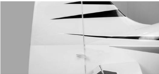
Überprüfen Sie ob das Seitenruder mit den Scharnieren genau zur Dämpfungsflosse passt. Stellen Sie sicher, dass alle Scharniere genau in einer Linie liegen und dass sich das Ruderblatt frei bewegen kann. Entfernen Sie die Komponenten wieder von der Dämpfungsflosse.
