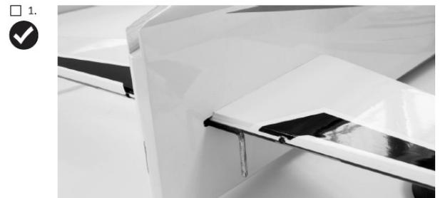
Bringen Sie den Verbinder an bei Variante mit einem Höhenruderservo, dann schieben Sie das Höhenleitwerk vorsichtig durch den Schlitz, nehmen Sie die Bügelkanten als Referenzlinien. Stellen Sie sicher, dass die gelbe Seite nach oben, zeigt. Führen Sie das untere Flächensteckrohr im Rumpf ein und bringen Sie die rechte und linke untere Tragfläche an. Stellen Sie sicher, dass die Flächenhälften gut passend sitzen. Befestigen Sie die Flächenhälften mit den Schrauben.
