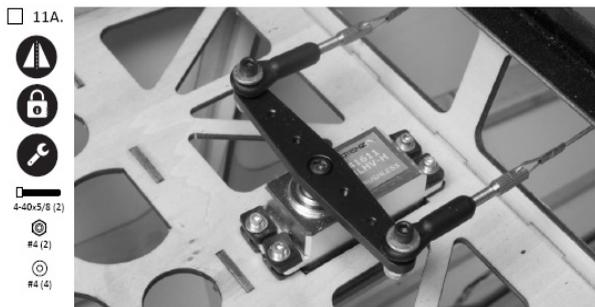
Installieren Sie die Kugelgelenke mit den Zugseilen am Abtriebshebel des Seitenruder Servos. Halten Sie das gleiche Schema wie bei der Montage des Querruder servos ein.
