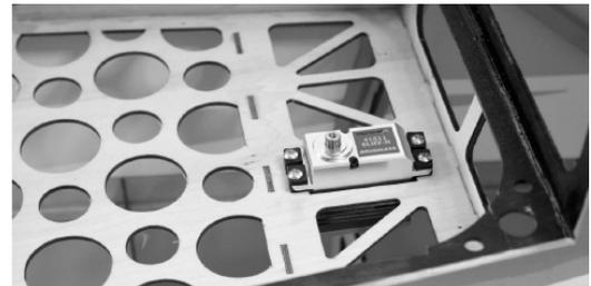
Bringen Sie das Seitenruderservo in der Aussparung unter der Kabinenhaube an. Nehmen Sie die gleichen Schritte vor, wie bei der Montage der Querruderservos. Bei dieser Position des Seitenruderservos sind keine Servoverlängerungskabel nötig. Das Servo muss mit dem Antrieb nach vorn montiert werden.
