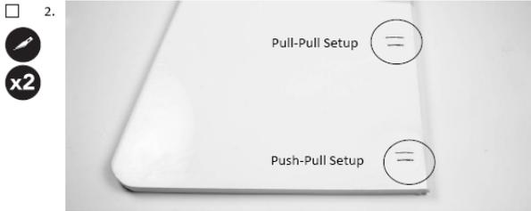
Suchen Sie am Seitenruder die Aussparungen für die Ruderhörner des Seitenruders. Es gibt zwei Positionen für die Steuerhörner am Seitenruder abhängig von Ihrem Setup. Bei der Verwendung der Doppel-Ruderanlenkung entfernen Sie die Abdeckung auf beiden Seiten der oberen Steuerhorn Steckplätze (Pull-Pull). Wenn Sie ein Push Pull Seitenruder-Setup anwenden, entfernen Sie nur von der rechten Seite im unteren Bereich die Abdeckung für den Steuerhorn Steckplatz.
