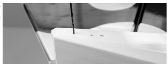
Bohren Sie die beiden Löcher mit einem 2 mm Bohrer, genau an den Markierungen vor. Schrauben Sie zwei M3 x 10 Holzschrauben ein, um ein Gewinde in das Holz zu schneiden. Entfernen Sie die Schrauben wieder und geben Sie ein wenig CA-Kleber in die Gewindgänge, damit die aushärten.
