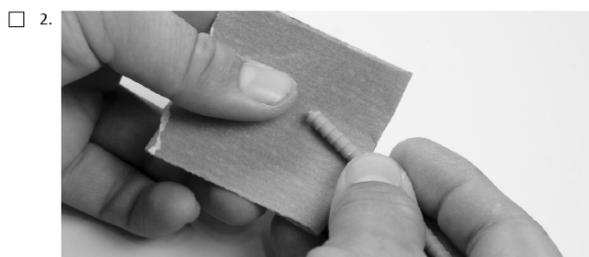
Bereiten Sie die Querruderscharniere vor, schleifen Sie den Bereich, der in den Flügel eingefügt wird mit Schleifpapier mittlerer Körnung gut an. Seien Sie vorsichtig, dass nicht zu viel Material entfernt wird. Verwenden Sie Isopropyl Alkohol um die Scharniere zu entfetten. Mit einem Papiertuch entfernen Sie überschüssige Ablagerungen an den Scharnieren.
