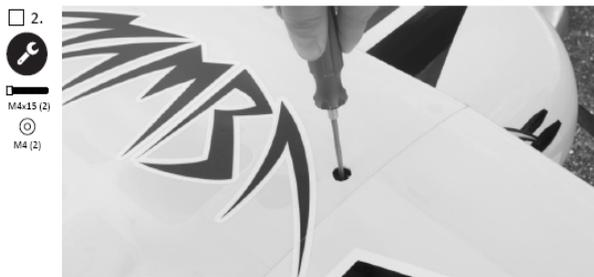
Wiederholen Sie die gleichen Arbeitsschritte für die oberen Tragflächen. Gehen Sie umsichtig vor, wenn Sie mit dem Schraubendreher ausrutschen, beschädigen Sie evtl. die Folie.
