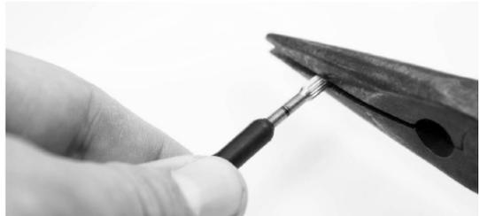
Mit Hilfe einer Zange drehen Sie das Gewinde der Ringöse etwa bis zur Mitte in den Kugelkopf ein.
