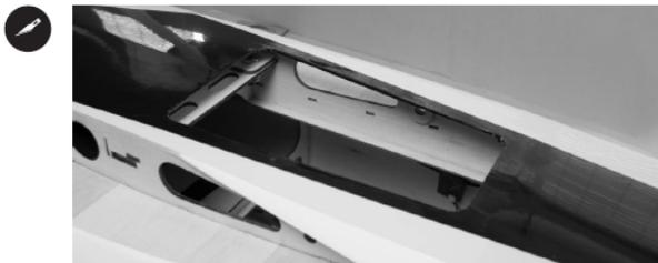
Um die Kühlung zu unterstützen, entfernen Sie einen Teil der Abdeckung im Boden des Rumpfes, wie im obigen Bild dargestellt. Lassen Sie ca. 3 mm Folie stehen und bügeln Sie diese nach innen als zusätzliche Abdeckung und Abdichtung der Ränder.
