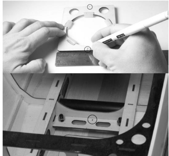
Verwenden Sie ein Lineal und einen Bleistift, um eine Mittellinie auf der Oberseite des Spants anzubringen, sowie die Position des Kraftstofftanks zu markieren.
