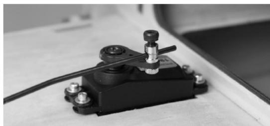
Dieser Schritt gilt für alle Servopositionen. Montieren Sie den Schnellverbinder am Servohebel. Verwenden Sie zur Sicherung der Schraube blauen Sicherungslack. Für die Montage werden folgende Teile benötigt:
