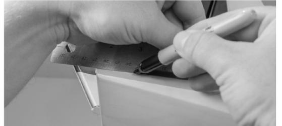
Verwenden Sie einen Filzstift und ein Lineal um die Mittellinie für die Spornrad Halterung auf das Ende des Rumpfes zu zeichnen. Zeichnen Sie nur ein so langes Stück auf, wie die Halterung lang ist.
