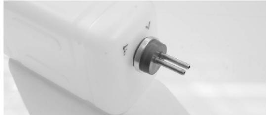
Nehmen Sie den Sicherheitsring zur Hand. Beachten, dass es zwei Fasen auf beiden Innenrändern dieses Rings gibt. Eine größere Fase auf der einen und auf der anderen eine kleinere Fase.
