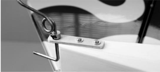
Nach dem Trocknen bringen Sie die Halterung an, schrauben Sie sie mit Unterlegscheiben fest. Entfernen Sie mit Alkohol die Markierung der Mittellinie.
