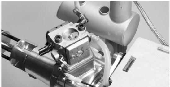
Schließen Sie die Kraftstoffzuleitung am Vergaser an, sichern Sie die Verbindungsstelle. Verwenden Sie hitze resistentes Material, wie z.B. eine Metallklemme.
