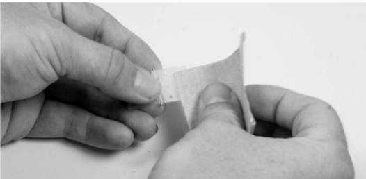
Mit Schleifpapier mittlerer Körnung schleifen Sie die Klebeflächen der Scharniere an. Entfernen Sie überschüssigen Schmutz mit einem Papiertuch und Isopropyl Alkohol. Geben Sie etwas Vaseline auf die Gelenkpunkte, wie es bei den anderen Scharnieren auch gemacht wurde.
