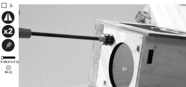
Benutzen Sie die Inbusschrauben und Unterlegscheiben um die Einschlagmuttern einzuziehen. Zuerst stecken Sie die Muttern von innen in die Bohrungen des Kopfspants, dann setzen Sie die Abstandhalter und die Schrauben ein und Sie sie an. Sichern Sie die Einschlagmuttern mit etwas Medium CA-Kleber.
