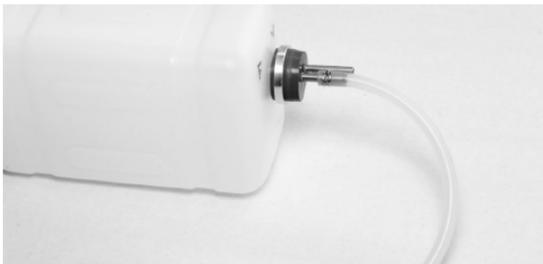
Verbinden einen etwa 300 mm langen Abschnitt des Kraftstoffschlauchs mit dem Einfüllstutzen des Kraftstofftank. Sichern Sie die Verbindungsstelle am zum Messingrohr mit einer der vorgesehenen Kraftstoffleitungen-klemmen.
