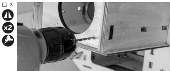
Die Markierungen für die Motormontage eines DA-70 und DA-60 sind durch einen Laser auf der Montageplatte markiert. Bohren Sie mit einem 3 mm Bohrer die Markierungen im Kopfspant vor.
