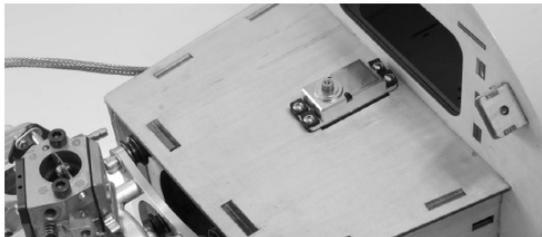
Dieser Schritt gilt für alle Servopositionen. Installieren Sie das Gasservo mit der Abtriebswelle zur Frontseite des Flugzeugs. Verwenden Sie den Sender, um die Servomitte einzustellen. Dann installieren Sie einen ca. 20 mm langen Servohebel auf der Seite des Servos, die am besten zum Gashebel am Motor passt. Im Fall eines DA-70 ist das die rechte Seite des Rumpfes (aus der Sicht des Piloten).
