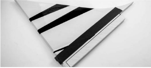
Nehmen Sie ein Klammernmesser und entfernen Sie ganz vorsichtig die Folie ca. 3 mm unterhalb der Markierung, wie auf dem Photo zu sehen. Verletzen Sie keinesfalls die Struktur der Dämpfungsfäche.
