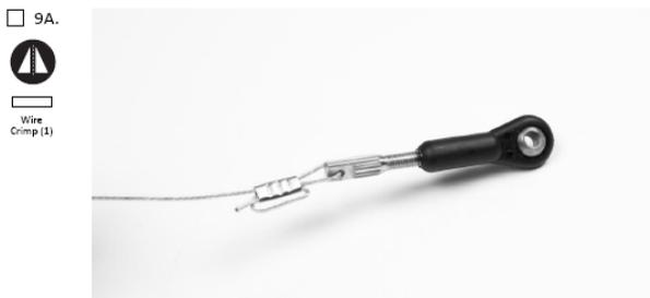
Nehmen Sie ein Ende der Seillitze und fädeln Sie es durch das Crimp Röhrrchen, durch die Öse und wieder durch das Crimp Röhrrchen. Zur besonderen Sicherheit können Sie die Litze nochmals durch das Röhrrchen ziehen. Mit einer Crimpzange drücken Sie das Röhrrchen fest zusammen, so dass sich das Seil nicht lösen kann.
