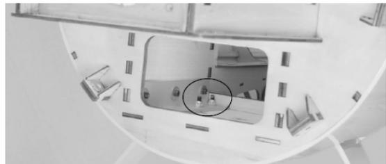
Mit dem Rumpf in Rückenlage setzen Sie das Fahrwerk im Rumpf ein, es muss dabei nach vorn zeigen. Mit einer M4 x 20 Schraube mit einer M4 Unterlegscheibe, befestigen Sie das Fahrwerk am Rumpf. Stecken Sie die Schraube von außen nach innen in den Rumpf und verschrauben Sie das Fahrwerk innen mit einer M4 Stopmutter. Wiederholen Sie diese Vorgänge für die restlichen 3 Schrauben.
