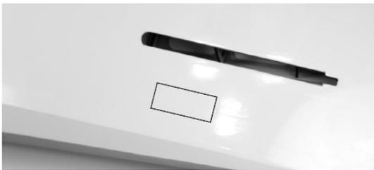
Lokalisieren Sie die Aussparungen des / der Höhenruderservos. Mit einem Hobbymesser, entfernen Sie die Abdeckung. Lassen Sie 3 mm der Folie in die Innenseiten der Schlitz hineinragen. Schneiden Sie die Ecken in einem 45 Grad Winkel ein und bügeln Sie diese Überstände innen fest, um den Schlitz nach unten abzudichten.
