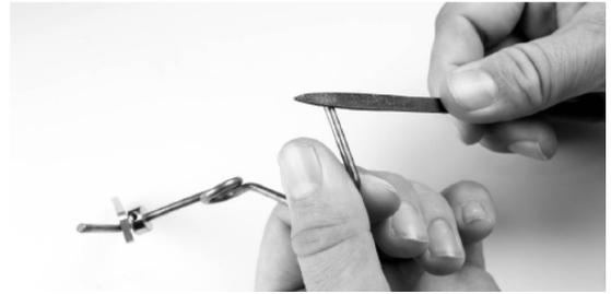
Benutzen Sie eine flache Schlüsselifeile um zwei gegenüberliegende Flächen am Sporn, für die Schrauben des Stellrings anzubringen.
