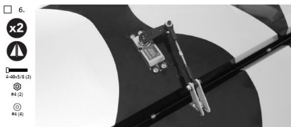
Montieren Sie die Gestänge am Servohebel und den Ruderhörnern. Dafür benötigen Sie folgende Teile:
