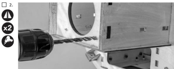
In einem zweiten Schritt bohren Sie die Löcher auf 8 mm auf, stellen Sie sicher, dass die Bohrungen genau für die Einschlagmuttern passen, die im nächsten Schritt angebracht werden.
