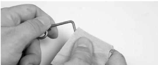
Bereiten Sie den Sporn für das Heckfahrwerk vor, schleifen Sie die Klebefläche des L förmig gebogenen Drahtes mit Schleifpapier mittlerer Körnung an, damit eine gute Verklebung mit dem Seitenleitwerk erfolgen kann.
