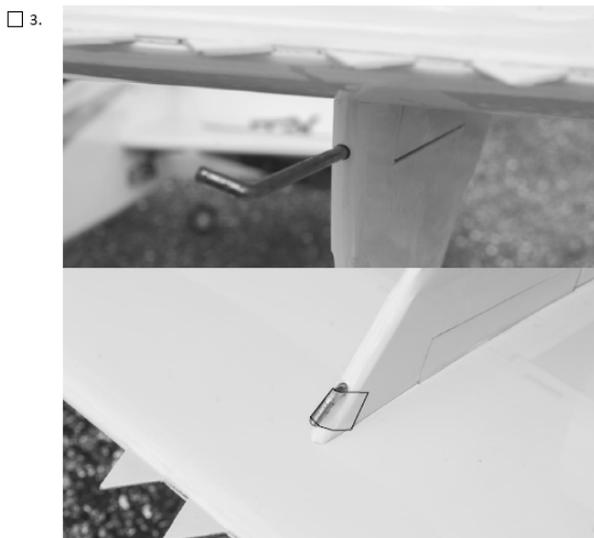
Stellen Sie sicher, dass bei den Flächenstreben die Steckbolzen von den Streben entfernt sind. Schieben Sie die Strebe auf die Anformungen bis sie einrasten.
