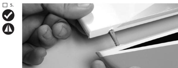
Testen Sie ob beiden Höhenruderrhälften passen, indem Sie die Ruder auf die Scharniere und den Verbindungsdraht (bei Variante mit einem Höhenruderservo) probe-weise aufstecken. Stellen Sie sicher, dass die Ruderrhälften genau mit der Hinterkante es Leitwerks fluchten. Sollte das nicht der Fall sein, beheben Sie den Fehler durch vorsichtiges Biegen des Verbinders.
