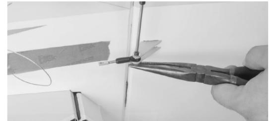
Montieren Sie den Kugelkopf am Seitenruderhorn. Ziehen Sie die Inbusschraube mit einem entsprechenden Schraubendreher fest. Für die Stopmmutter nutzen Sie eine Zange oder einen entsprechenden Schraubenschlüssel. Montieren Sie den Kugelkopf wie bei den Quer- und Höhenruderanlenkungen.
