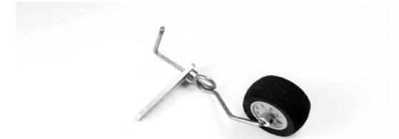
Montieren Sie das Heckrad mit Hilfe von zwei M3 Stellringen. Nach der Montage des inneren Stellringes als Abstandhalter, geben Sie einen Tropfen Leichtöl auf der Achse und schieben das Rad auf die Achse. Installieren Sie den anderen M3 Stellring. Stellen Sie sicher, dass die Schrauben auf die zuvor angebrachten Flächen greifen. Sichern Sie die Schrauben Sicherungslack. Stellen Sie sicher, dass sich das Spornrad frei dreht.
