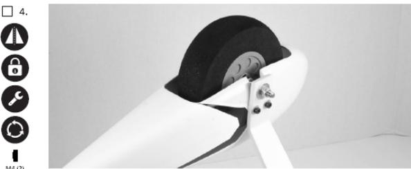
Schieben Sie einen M4 Stelling ziehen Sie die Schrauben so an, dass Sie auf die angeschliffenen Flächen greifen. Sichern Sie die Schrauben mit blauem Sicherungslack. Schieben das Hauptrad auf die Achse, gefolgt von einem zweiten Stelling, den Sie genau wie zuvor befestigen. Achten Sie darauf, dass sich das Rad frei drehen kann.
