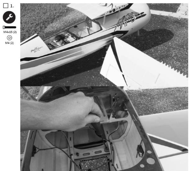
Entfernen Sie die Kabinenhaube vom Rumpf. Schieben Sie das Steckrohr in eine der unteren Tragflächen. Dann schieben Sie das Rohr mit aufgesteckter Fläche in den unteren Flächenrohrstützen.
