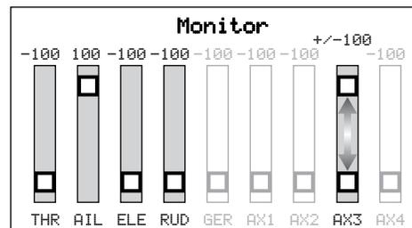
Cet exemple de moniteur de canal montre les positions des manches pour l'attribution d'un commutateur, la sélection du commutateur sur Aux3 et une course +/- 100 % sur le commutateur.
