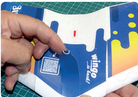
34. ... damit die Trimmkammer von hinten mit dem Finger wieder geöffnet werden kann, um ggf. die Trimmung zu verändern.
