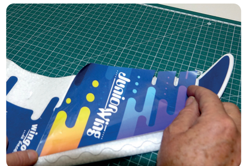
21. Linke Dekorsatzfläche, wie dargestellt, ausrichten und aufkleben. Es entsteht ein Spalt zwischen den beiden Dekorteilen. Wichtig ist, dass die Turbulator-Schlange nicht überklebt wird!
