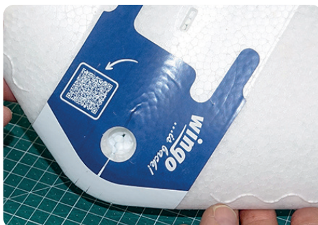
20. Als Zentrierpunkt für das exakte Aufkleben dient das Loch der Trimmkammer.
