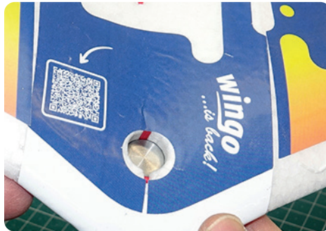
29. Zeigt Trimmgewicht bis zum Boden eingedrückt = OK.
