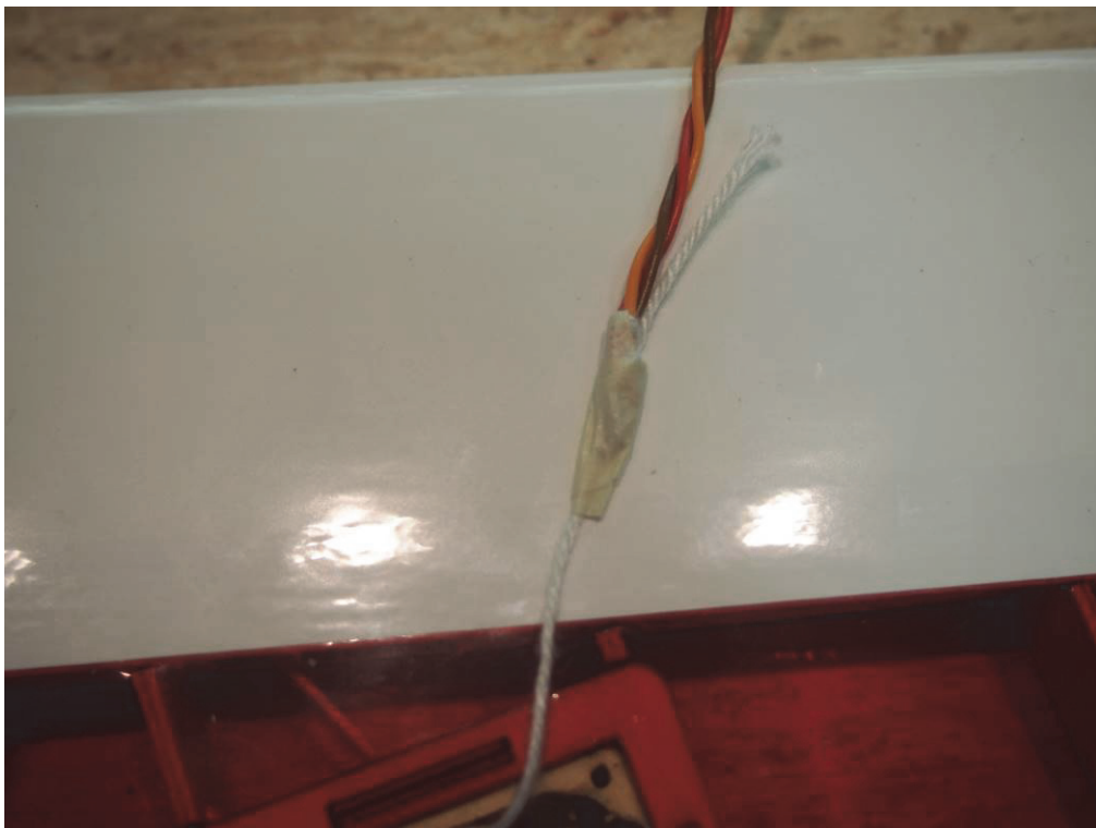
Bild 12, Verbindung der Schnur zum Durchziehen und des Servokabels
