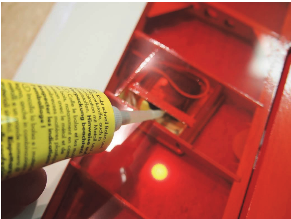
Bild 9, Fixieren des Servos vor dem eigentlichen Festkleben
