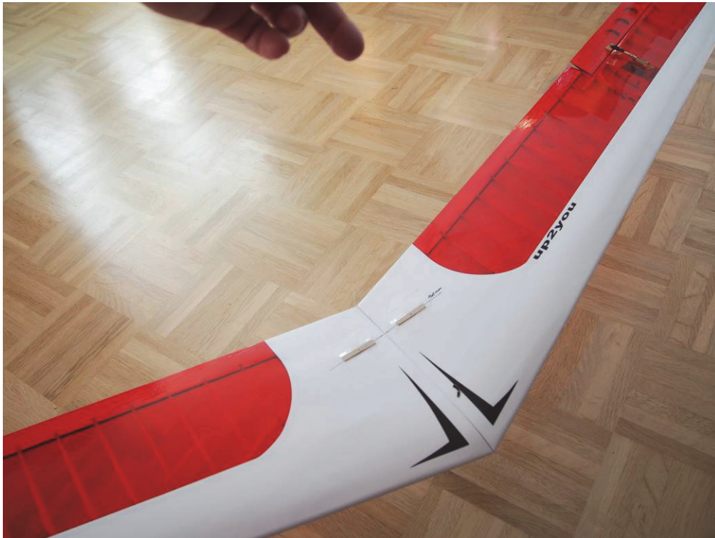
Bild 22, Kontrolle ob der Schwerpunkt nach dem Einkleben an der korrekten Stelle sitzt
