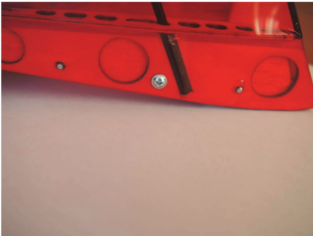
Bild 5, Winglet fertig montiert
