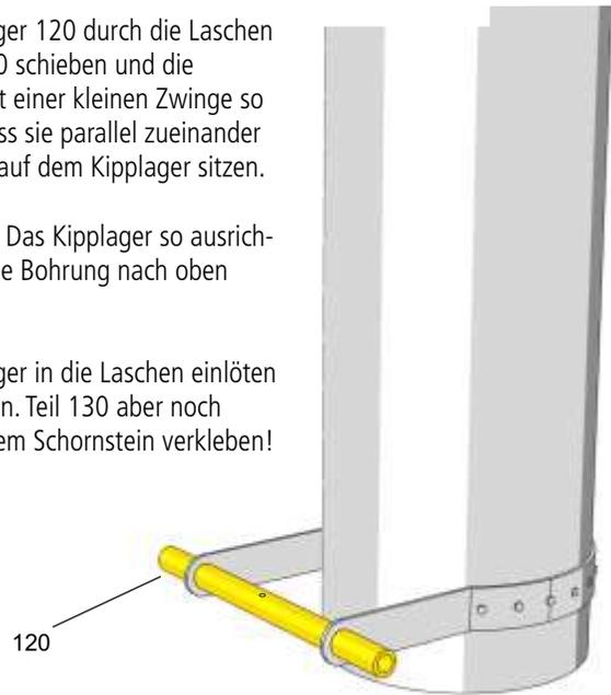
39 Den Schornstein im Kippmechanismus auf dem Kesselhaus montieren. Den Schornstein auf das Dach des Kesselhauses drücken und die Manschette 130 horizontal ausrichten. Mit etwas Sekundenkleber an den Schornstein kleben.
