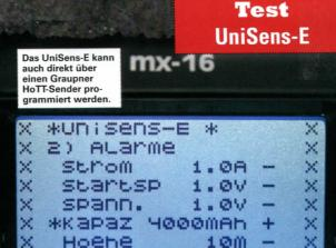
werden. Nutzt man das Multiplex M-Link, so können die zu übertragenden Werte verschiedenen Kanälen (Anzeizugewiesen gepositionen) werden. Neben M-Link werden noch Graupner HoTT und Jeti Duplex unterstützt.
