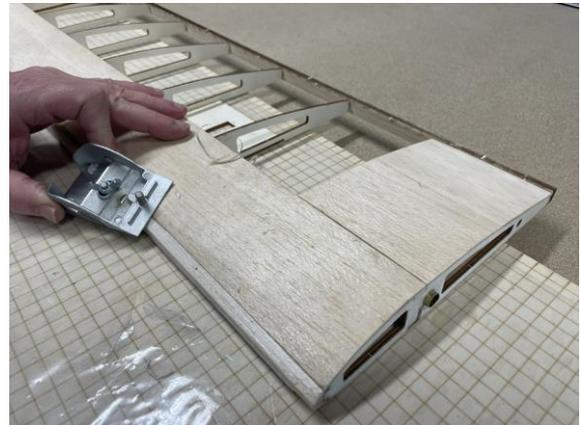
Kleines Sperrholzteil aus Abfallmaterial wie gezeigt aufkleben als Stopper für den Flächenverbindungsstab.
