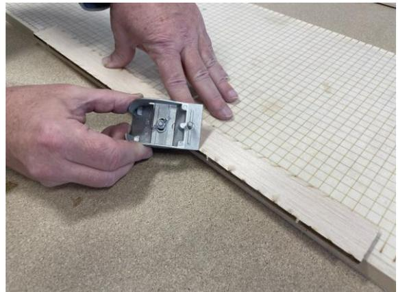
Seitenleitwerk und Höhenleitwerk **NACH** dem Bespannen rechtwinklig an den Rumpf kleben.
