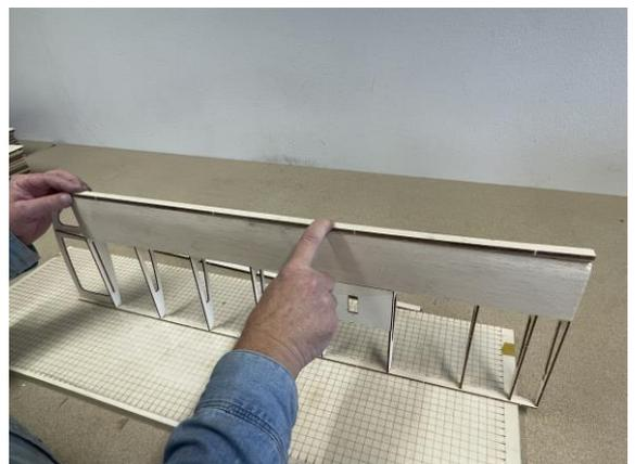
Während des Trocknens mit Klebeband fixieren.
