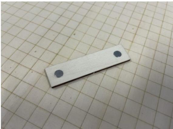
Die beiden Zapfen C7 in das Teil C2 einkleben. In den mittigen Schlitz wird Bauteil C8 geklebt (o.Abb.)
