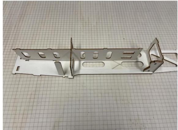
Teile B9 und B6 in die Rumpfsseitenwand kleben.
