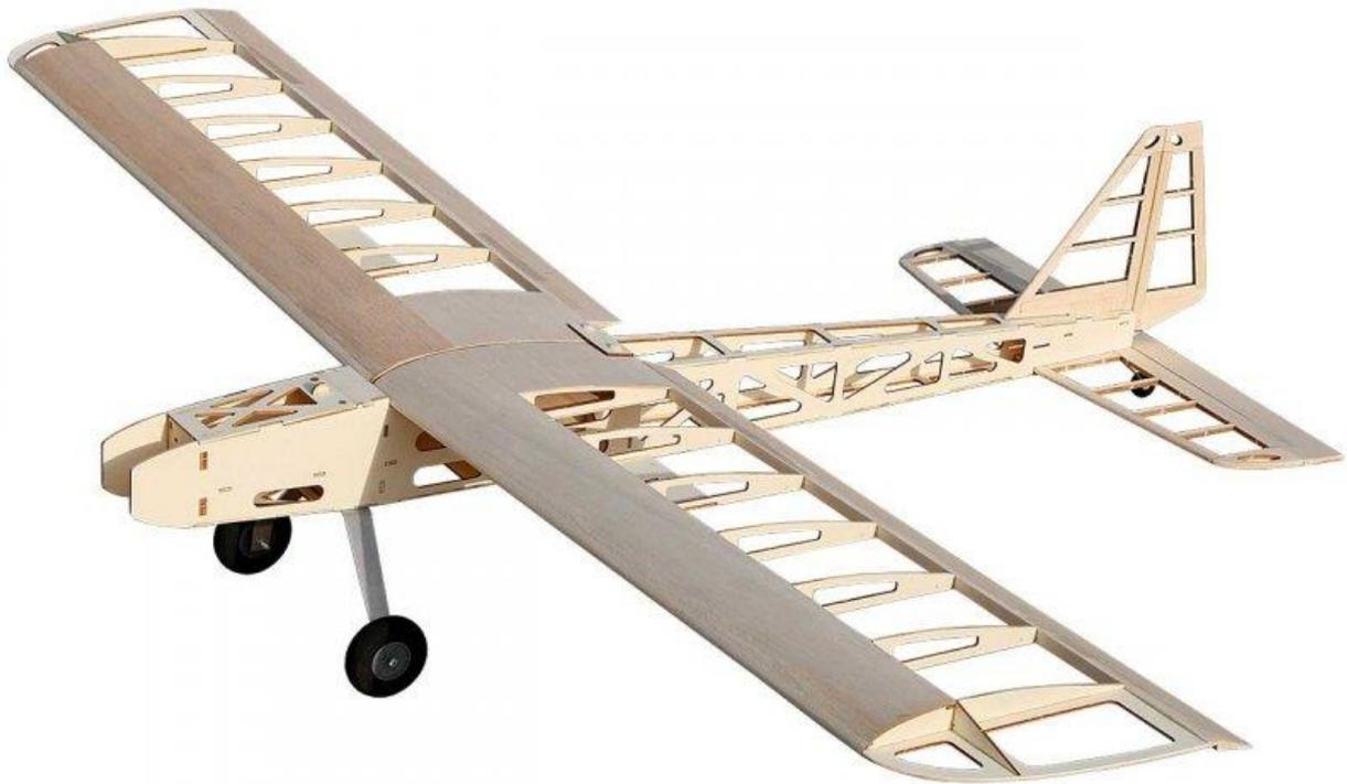
Nach Fertigstellung des Rohbaus kann das Modell bespannt werden. Wir empfehlen Polyester Bügelfolie. Zuvor sollte das Modell vollständig von Staubrückständen befreit werden. Verrußte Schnittstellen vom Laserschneiden vorsichtig abschleifen. Die besten Ergebnisse erzielen Sie mit dem Folienbügeleisen, z.B. Best.Nr. C9758. Nutzen Sie unbedingt einen Schutzbezug Best.Nr. X9983, um ein Verkratzen der Folie während des Bügelns zu verhindern.
