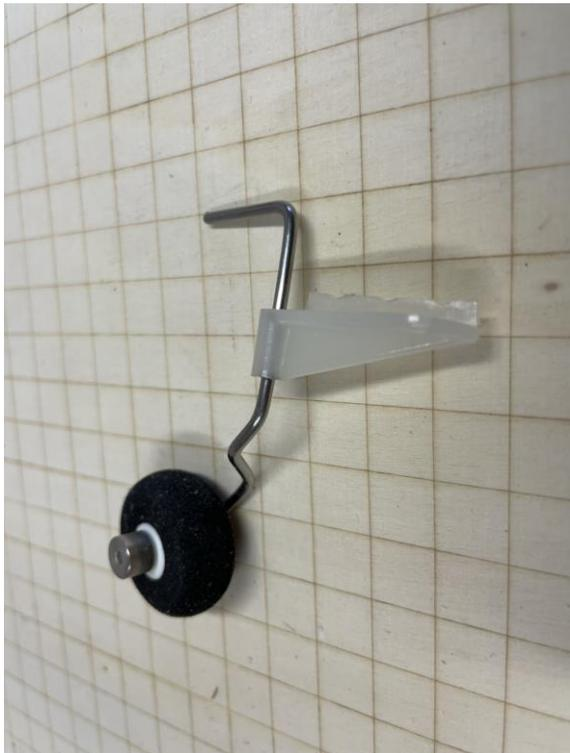
Das Heckfahrwerk wird mit zwei Schrauben befestigt.
