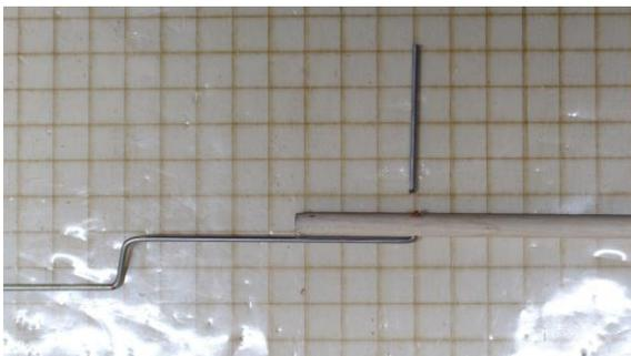
Draht mit 5-min-Epoxy an der Schubstange verkleben. Schrumpfschlauch darüber schieben und mit Heißluftfön schrumpfen.
