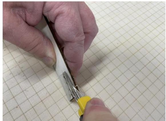
Fahrwerksdraht wie gezeigt mit einer Zange biegen. Anhand des 10mm – Rasters am Baubrett sind die Biege Maße ersichtlich.
