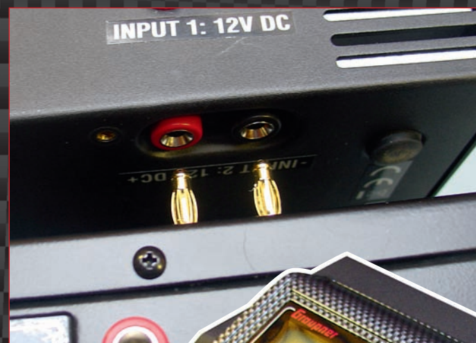
Beim Aufsetzen des La- ders auf das Netzteil erfolgt die elektrische Ver- bindung automatisch.
