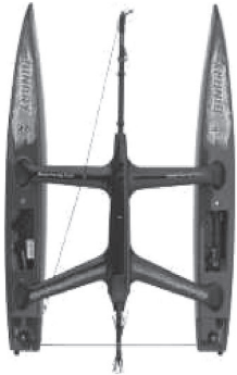
Vormontierter Rumpf mit Servos, Empfänger und Batteriebox
