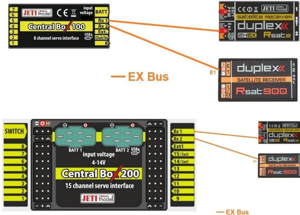
Central Box 100 oder 200 mit zwei 2,4Ghz Empfängern und 900Mhz Backup Empfänger:
