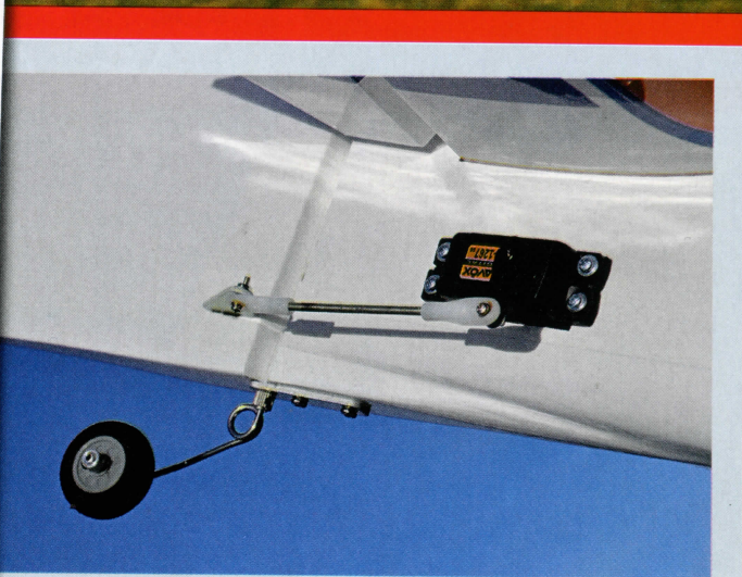
Auf direktem Wege: Die selbst hergestellten M2,5-Anlenkungen
