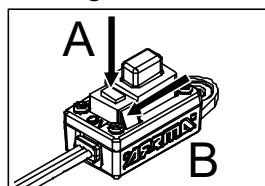
1. Verbinden Sie den Akku. Drücken und halten Sie den Set-Knopf und schalten Sie den Regler ein. Die rote LED wird blinken.
