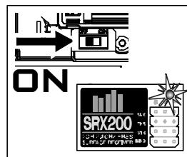
Schalten Sie den Regler ein. Die rot LED blinkt, und zeigt damit an, dass sich der Empfänger im Bindemode befindet.
