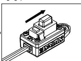
5. Pour enregistrer le réglage, mettez l'ESC hors tension. Redémarrez le processus pour faire d'autres modifications de réglages
