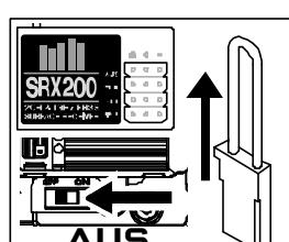
Entfernen Sie den Bindestecker und schalten dann den Empfänger aus um die Einstellungen zu speichern.
