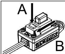
1. Brancher une batterie. Appuyez et maintenez enfoncé le bouton de réglage et allumez l'ESC. La LED rouge clignote.
