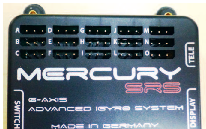
Die 15 beschrifteten Servoausgänge der Mercury SRS.
