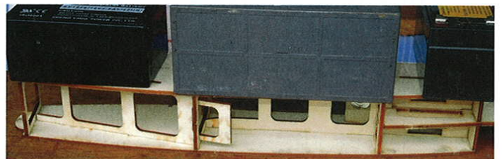
... danach die linke Rumpfseitenwand aufgesteckt und bis zum Durchtrocknen mit Ballast beschwert
