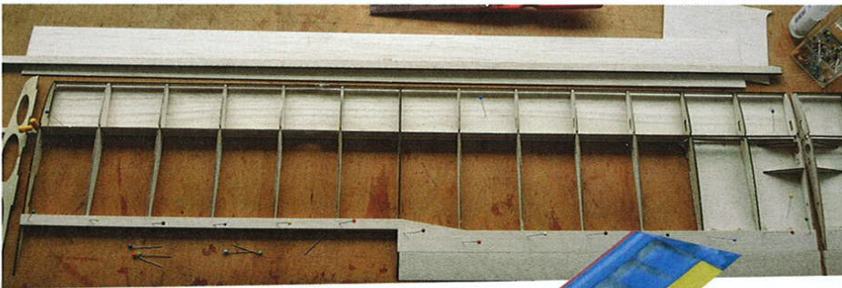
Unten: Auf der unteren Beplankung sind die Holmgurte, alle Rippen und die Endleiste bereits fixiert und festgeklebt
